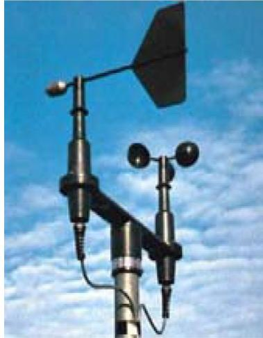
**Figura 2. Sensores de dirección y velocidad de viento.**
