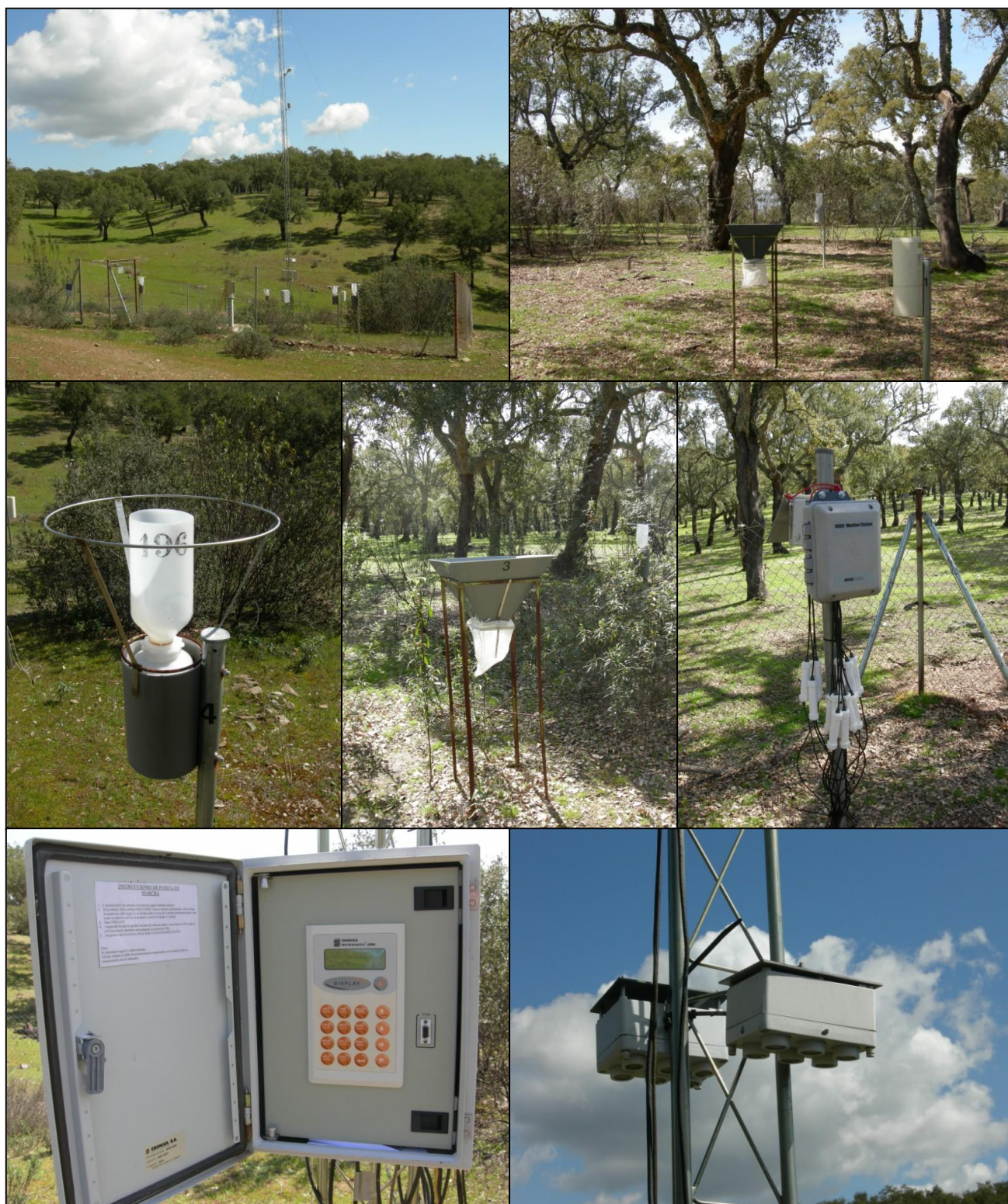
FIG 7: Parcela exterior. Torre meteorológica. Captador de desfronde y pluviómetro. Acumulador de deposición.. Sonda de humedad. Data-logger. Dosímetros pasivos
