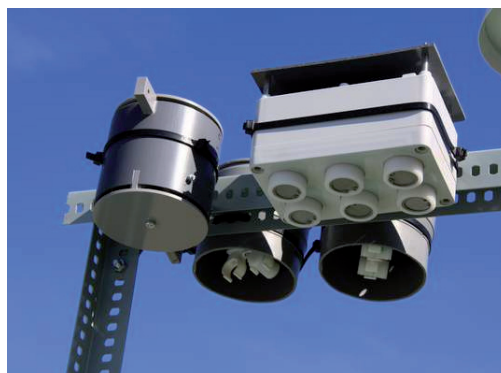
Figura 16. Dosímetros pasivos para medida de contaminantes gaseosos. Distintos modelos de dosímetros para el análisis de los niveles de ozono y óxidos de nitrógeno. Fuente: CIEMAT, CEAM, MARM-DG Medio Natural y Política Forestal.
