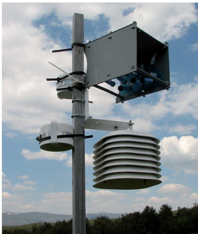
Figura 16. Dosímetros pasivos para medida de contaminantes gaseosos. Distintos modelos de dosímetros para el análisis de los niveles de ozono y óxidos de nitrógeno. Fuente: CIEMAT, CEAM, MARM-DG Medio Natural y Política Forestal.
