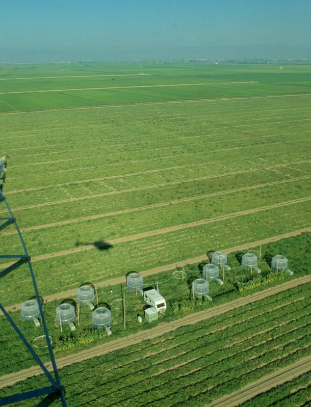
Figura 14. Instalación experimental de cámaras descubiertas ubicada sobre un campo de cultivo extensivo de sandía (delta del Ebro, Tarragona). Vista aérea y detalles de las cámaras desde el exterior e interior. Fuente: CIEMAT.
