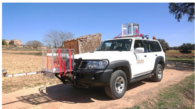
Figura 2. Izquierda, piezas de cartulina utilizadas en la prueba de la integridad de la muestra (prueba a). Derecha, instalación de dos colectores de insectos sobre un vehículo (pruebas b y c).
