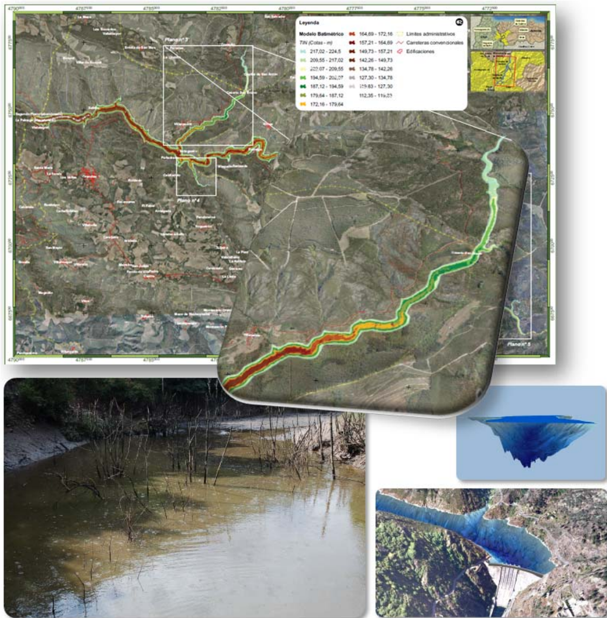
Figura 7. Ejemplo de estudio batimétrico de detalle desarrollado mediante software GIS e imagen representativa de los efectos de la bajada de un embalse
