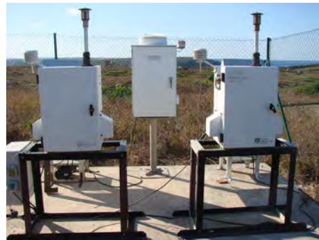
Equipos para la obtención de los datos de nitratos y amonios
