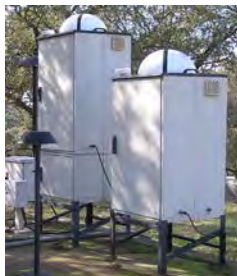
Equipos de recogida de agua de lluvia
