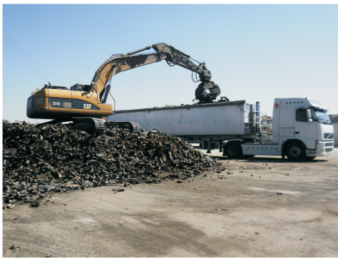
Carga de NFU con retroexcavadora con pinza
