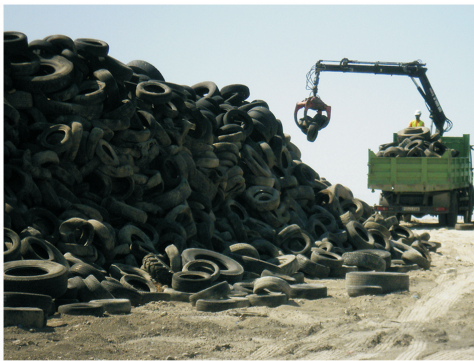
Carga de NFU con camión con grúa pulpo
