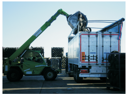
Carga de NFU con manipulador telescópico
