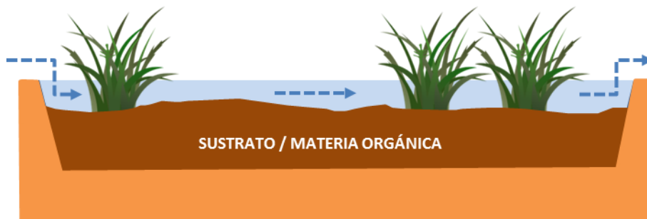
Esquema de funcionamiento de un humedal aerobio.
