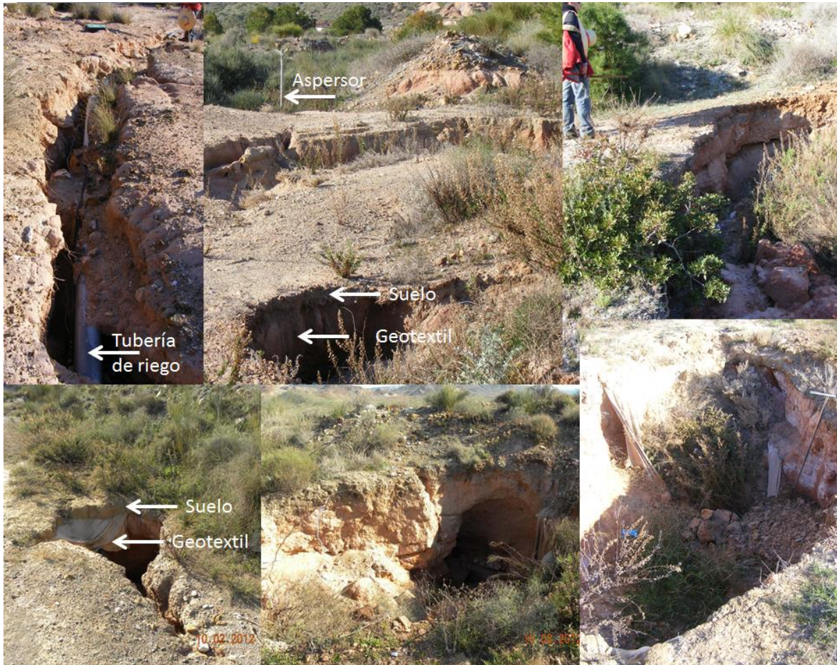
Figura 42. En la imagen se observa el espesor de la capa de suelo de unos 20 cm o menos y la capa de geotextil o geomembrana. Se aprecia diferentes formas de tubificación ligadas al sistema de riego. Al parecer el geotextil en ocasiones no se observa su continuidad lateral.
