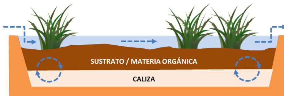
Esquema de funcionamiento de un humedal anaerobio.
