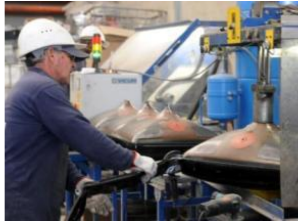
Fotografías 5.3.2.- Corte y extracción del fleje metálico en la unión del vidrio de pantalla y el de cono.
