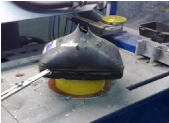
Fotografías 5.3.3.- Marcado del vidrio y rotura térmica.
