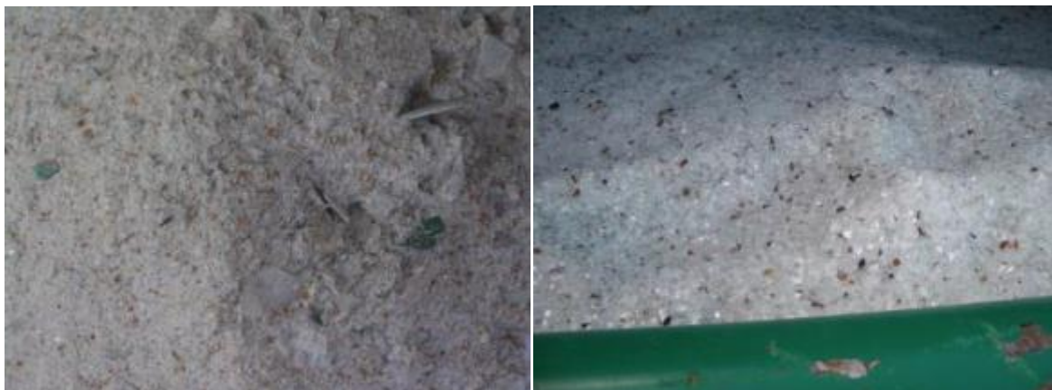
Fotografía 5.5.6.- Polvo de fósforo (izquierda) y vidrio (derecha).
