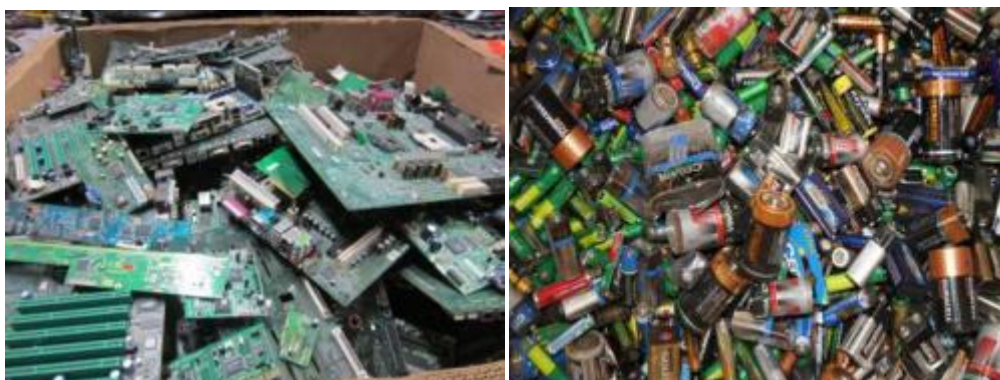
Fotografías 5.1.3- Detalle de las tarjetas de circuito impreso, pilas y baterías, como componentes extraídos de los RAEE.
