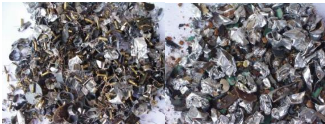
Fotografía 5.5.5.- Fracciones metálicas férricas (izquierda) y no férricas (derecha) resultantes de tratamiento.
