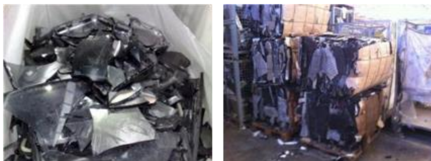
Fotografías 5.3.6.- Detalle de la fracción valorizable de vidrio y de plástico, una vez compactado.
