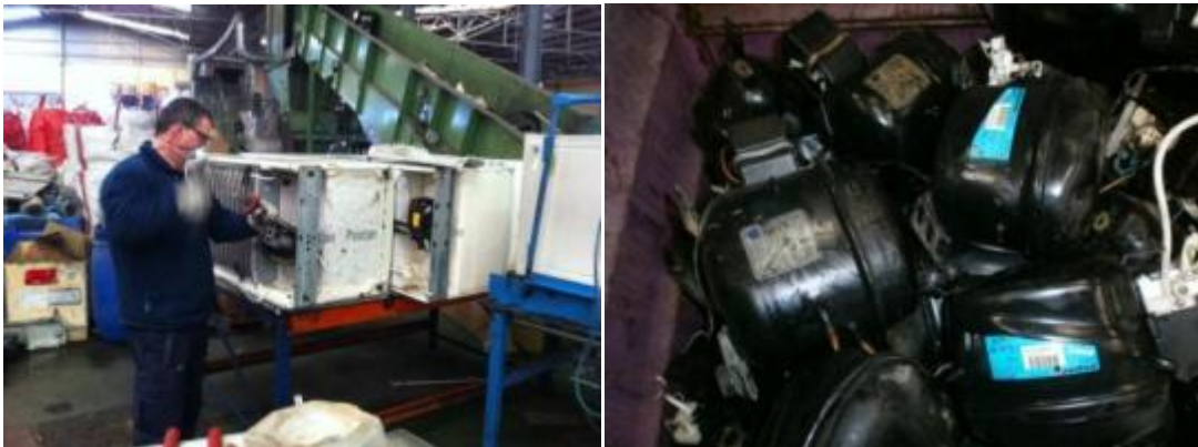
Fotografías 5.2.3.- Desmontaje, extracción y almacenamiento del compresor.
