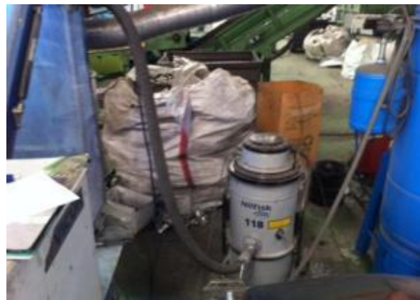
Fotografías 5.3.5.- Aspiración y almacenamiento del revestimiento fluorescente.
