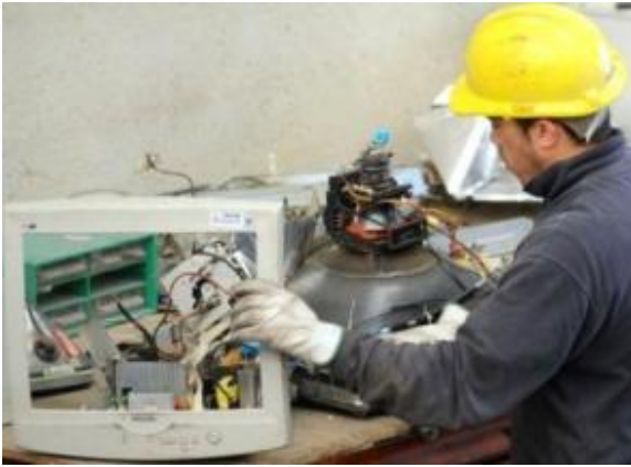
Fotografías 5.3.1.- Desmontaje de la carcasa exterior y eliminación del vacío.
