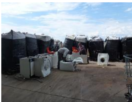
Fotografías 5.1.1.- Detalle de extracción manual previa de componentes de una lavadora.
