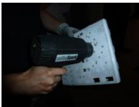
Fotografías 5.1.4.- Detalle de la utilización de un espectrómetro para la determinación de la composición de los plásticos in situ.
