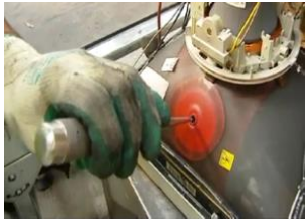
Fotografías 5.3.1.- Desmontaje de la carcasa exterior y eliminación del vacío.
