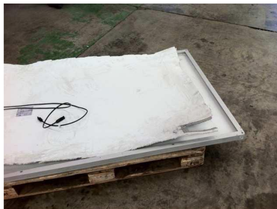
Fotografía 5.6.3.- Extracción de la caja de conexión y detalle del polímero plástico EVA (etileno vinil acetato).
