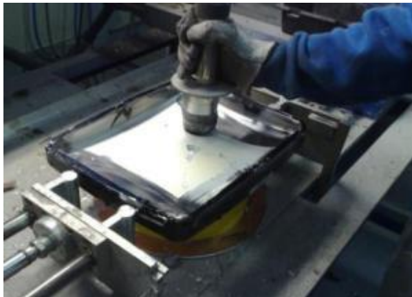
Fotografías 5.3.5.- Aspiración y almacenamiento del revestimiento fluorescente.
