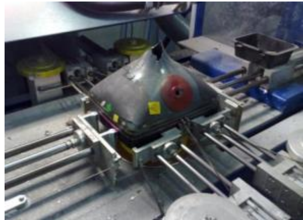
Fotografías 5.3.3.- Marcado del vidrio y rotura térmica.
