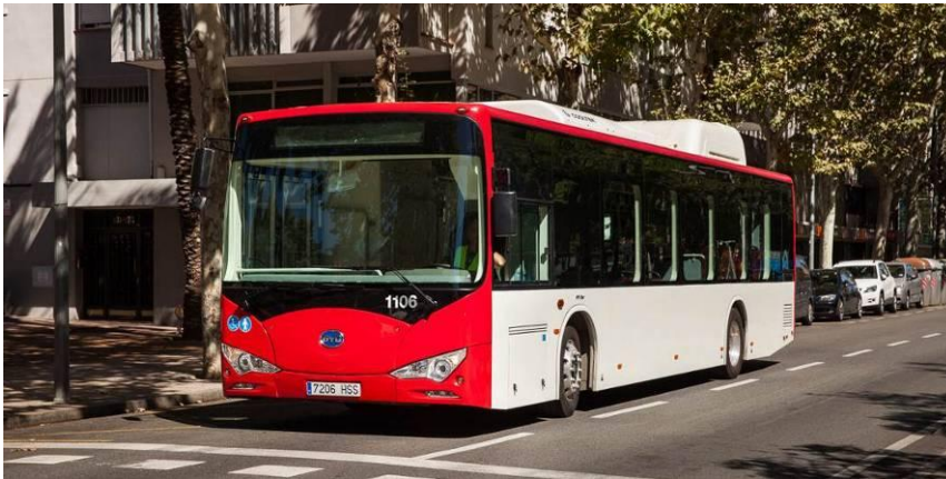
BUS ELÈCTRIC 12 m. - BYD BATERÍA ion-Li 324 kWh
