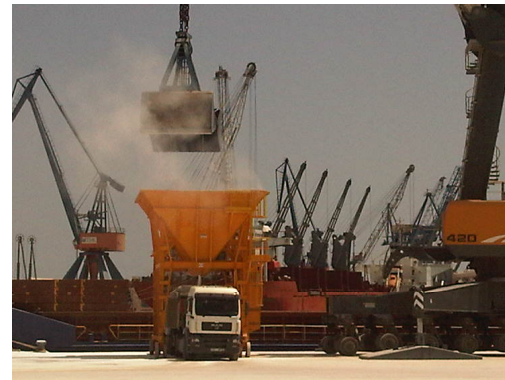
Carga de tolva con grúa móvil
