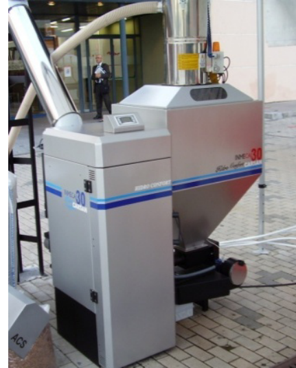
Caldera con depósito para pélets
