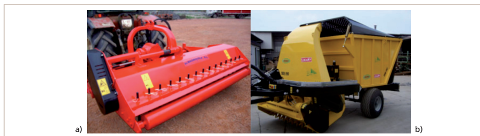
Figura 4.25. a) Trituradora de restos de poda; b) Trituradora-autocargadora compacta arrastrada por tractor
