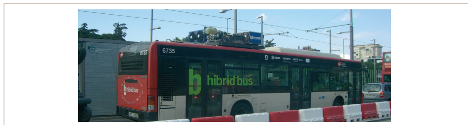
Figura 4.8. Autobús diésel de TMB (Transports Metropolitans de Barcelona) transformado a híbrido en pruebas en la Avda. Diagonal de Barcelona
