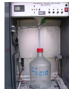
Equipo de recogida de lluvia para determinación de mercurio
