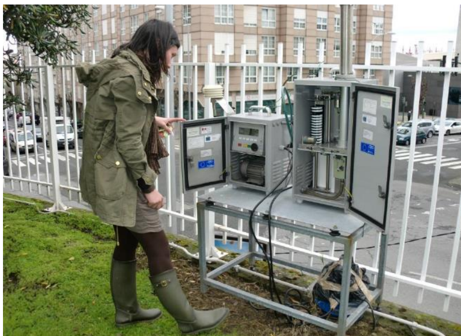
Imagen 16. Derenda LVS 3.1 con cabezal PM_{10} en la estación Riazor.
