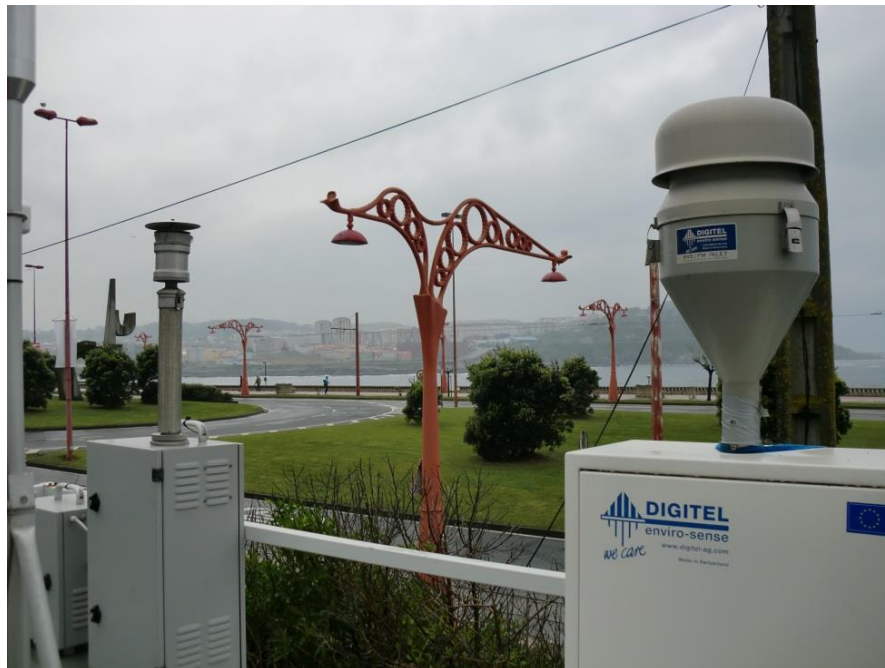
Imagen 14. Captadores gravimétricos con cabezales PM_{10} y PM_{2,5} en la estación Torre de Hércules.
