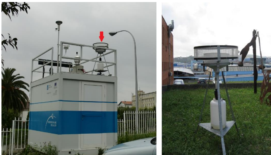
Imagen 12. Equipo colector de agua de lluvia (captador de polvo sedimentable) en Riazor.
