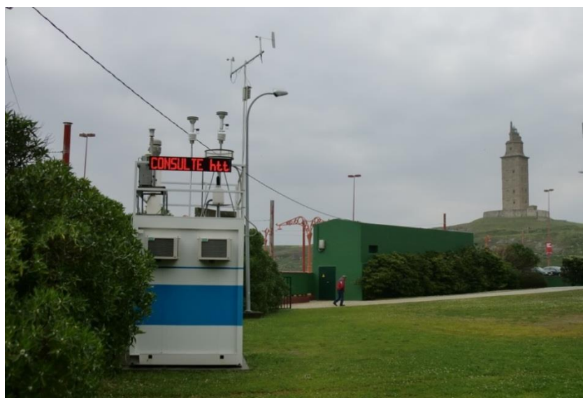
Imagen 15. Captadores gravimétricos con cabezales PM_{10} y PM_{2,5} Torre de Hércules.
