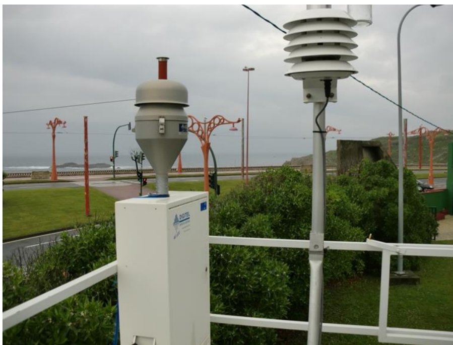
Imagen 13. CAV Digitel DHA-80 con cabezal PM 2,5 en Torre de Hércules.
