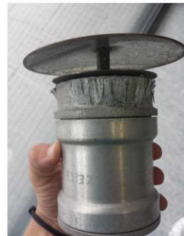
Imagen 9. Toberas de impactación y cabezal de PM 10 del analizador automático de Torre de Hércules con sal cristalizada
