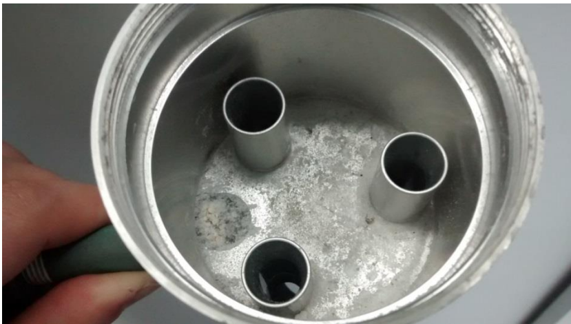
Imagen 9. Toberas de impactación y cabezal de PM 10 del analizador automático de Torre de Hércules con sal cristalizada
