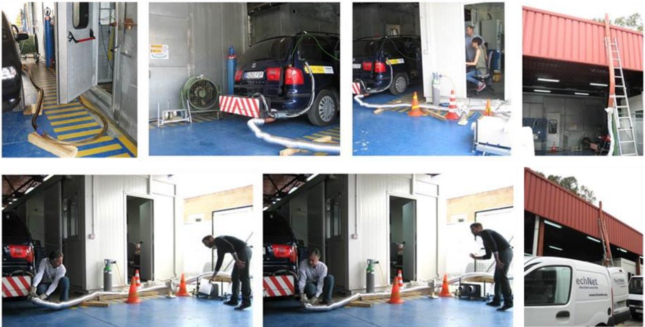
Imágenes 2. Banco motor (Laboratorio de motores de la Unidad de Emisiones Contaminantes, CIEMAT). Montaje experimental de los ensayos de medidas de emisiones con RSD6400 para el estudio de la dependencia de las ratios de emisión con la Potencia Vehicular Específica (VSP).
