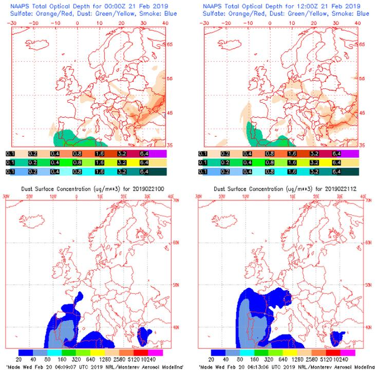
Espesor óptico de aerosoles a 550 nm (arriba) y concentración de polvo a nivel de superficie (abajo) previstos por el modelo NAAPS para el día 21 de febrero de 2019 a las 00 UTC y a las 12 UTC. ©Naval Research Laboratory (NRL), Monterey, CA.
