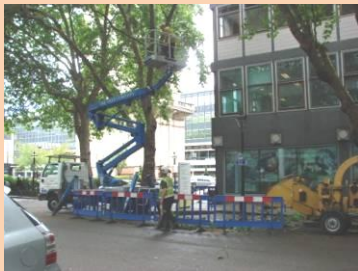
Poda de árboles seguida de trituración y carga en un camión en Londres. La trituradora es móvil y se traslada conjuntamente con el camión.
