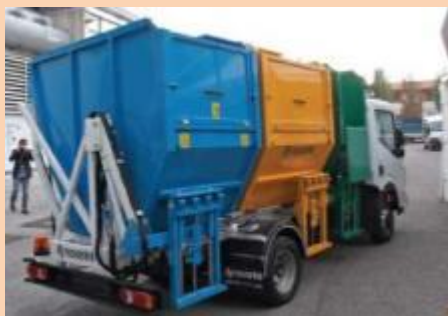
Vehículo satélite con tres compartimentos diferenciados, de carga lateral.
