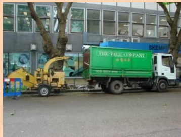
Poda de árboles seguida de trituración y carga en un camión en Londres. La trituradora es móvil y se traslada conjuntamente con el camión.
