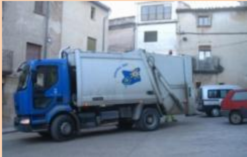
Vehículo de recogida monomaterial, de 12 m 3 , utilizado para la recogida de la Fracción Resto.
