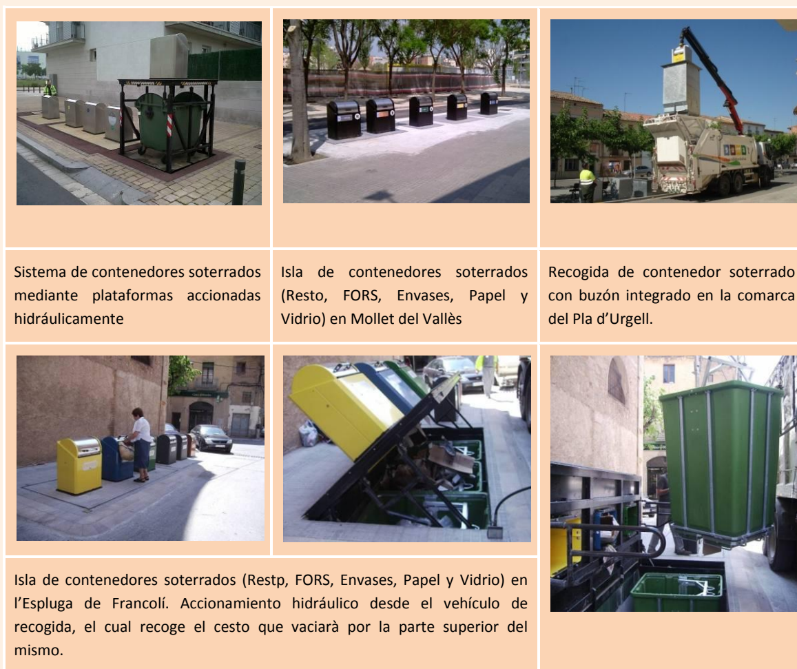
Figura 18. Recogida selectiva mediante contenedores soterrados.
