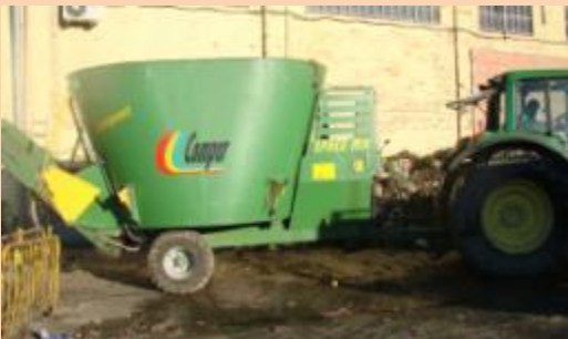
(c) equipo de mezcla, apertura de bolsas y homogeneización de la FORS con los Residuos Vegetales
