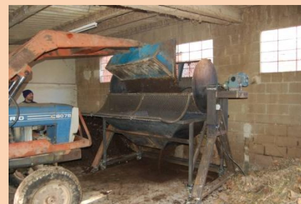
(f) Alimentación de compost, con pala, del sistema de tamizado
