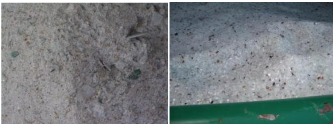
Fotografía 5.5.6.- Polvo de fósforo (izquierda) y vidrio (derecha).
