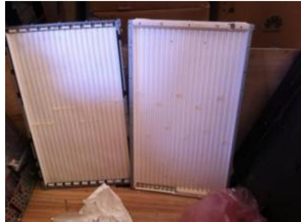
Fotografías 5.4.3.- Placas de circuitos impresos y lámparas de fondo CCFL.
