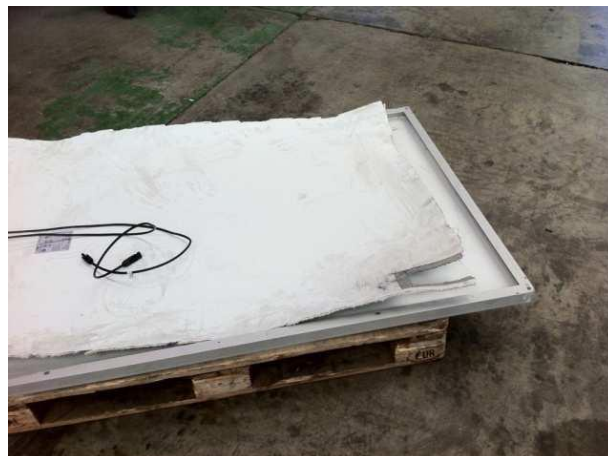
Fotografías 5.6.3.- Extracción de la caja de conexión y detalle del polímero plástico EVA.
