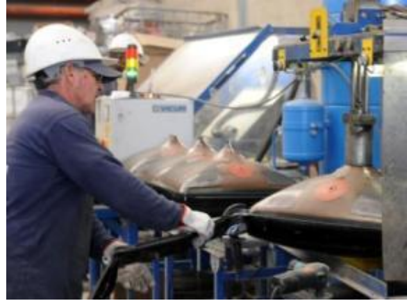
Fotografías 5.3.3.- Corte y extracción del fleje metálico en la unión del vidrio de pantalla y el de cono.
