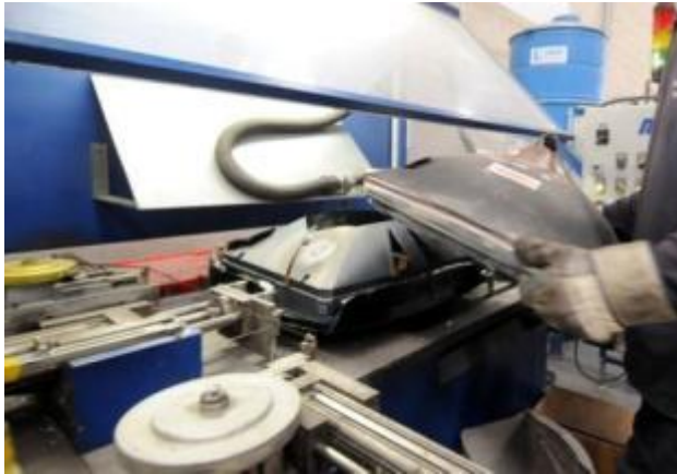
Fotografías 5.3.6.- Retirada del vidrio de cono y retirada de la máscara de sombra.
