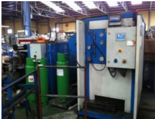
Fotografías 5.2.5.- Detalle de la máquina de extracción de gases y aceites. Detalle del almacenamiento del aceite y de los gases en bombonas separadas e identificadas.
