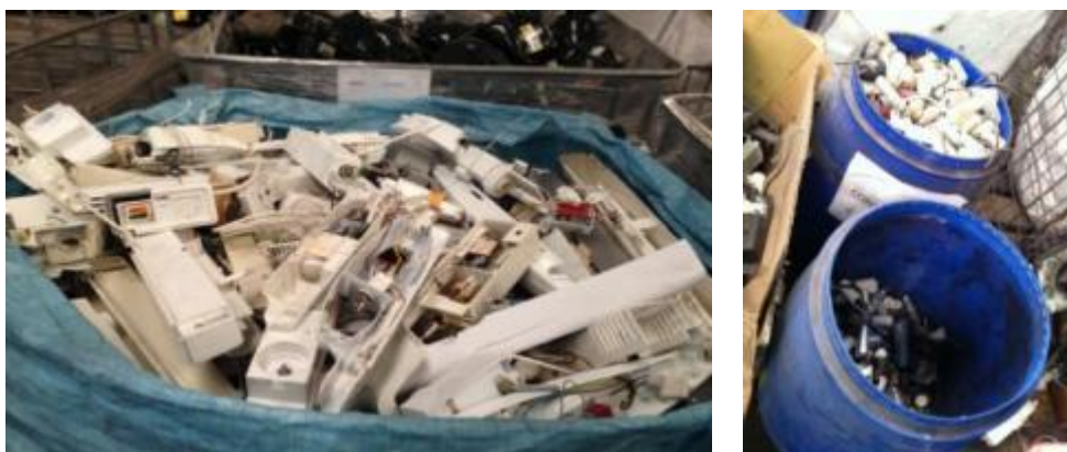
Fotografías 5.2.7.- Detalle de la segregación de componentes extraídos durante el proceso de tratamiento.
