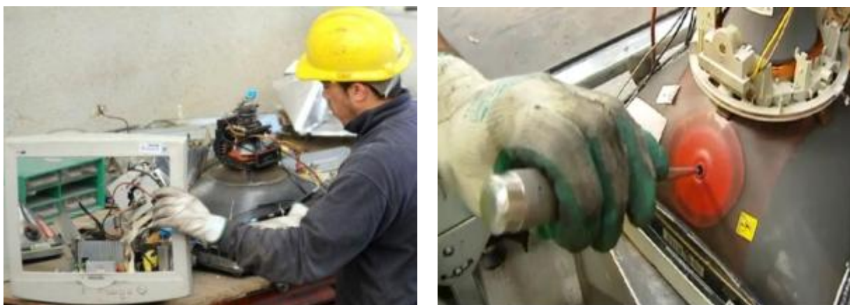
Fotografías 5.3.2.- Desmontaje de la carcasa exterior y eliminación del vacío.
