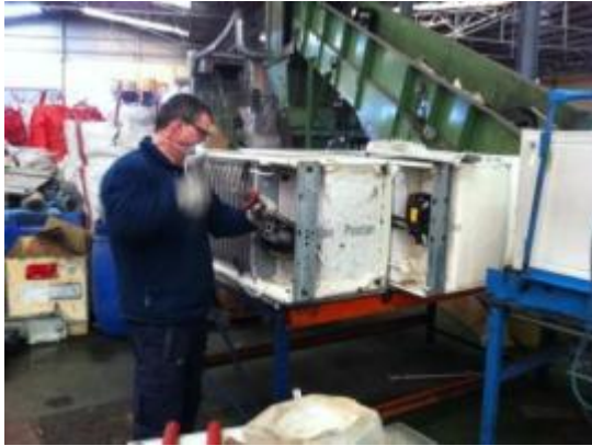
Fotografías 5.2.4.- Desmontaje, extracción y almacenamiento del compresor.
