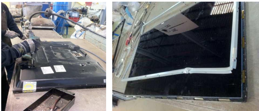
Fotografías 5.4.2.- Desmontaje previo de pantallas LCD.
