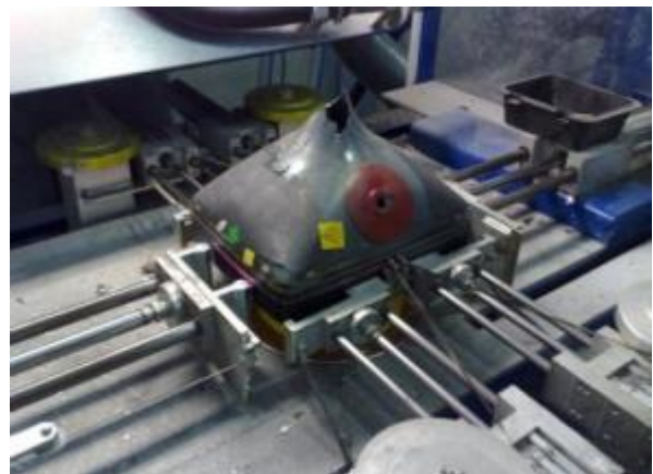
Fotografías 5.3.5.- Marcado del vidrio y rotura térmica.
