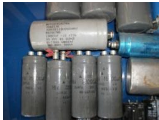
Fotografías 5.1.2.- Detalle de residuos de tóner, condensadores electrolíticos, como componentes extraídos de los RAEE.
