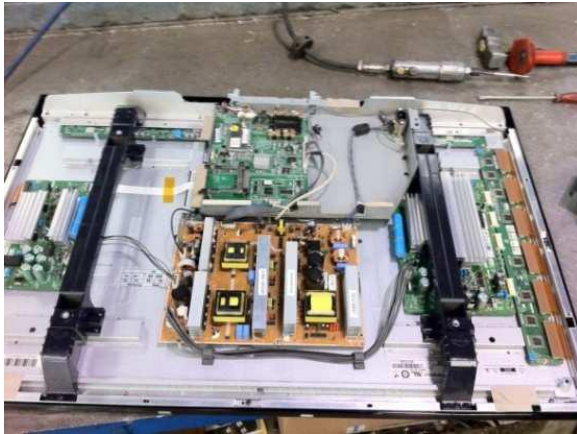
Fotografías 5.4.3.- Placas de circuitos impresos y lámparas de fondo CCFL.
