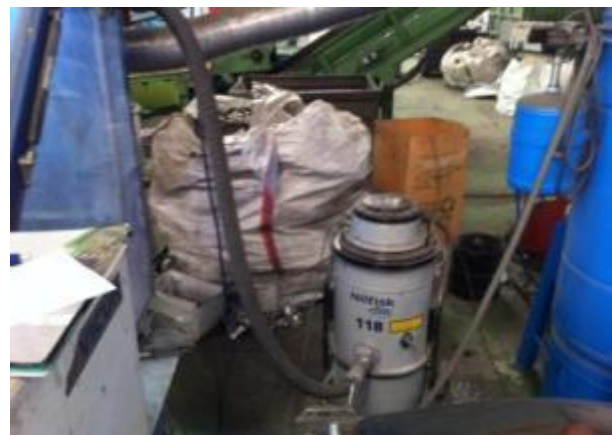
Fotografías 5.3.7.- Aspiración y almacenamiento del revestimiento fluorescente.
