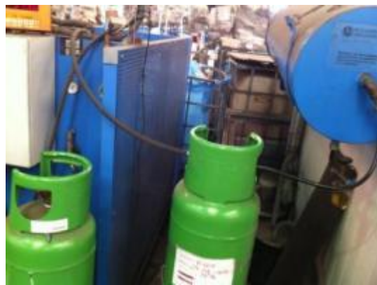
Fotografías 5.2.5.- Detalle de la máquina de extracción de gases y aceites. Detalle del almacenamiento del aceite y de los gases en bombonas separadas e identificadas.
