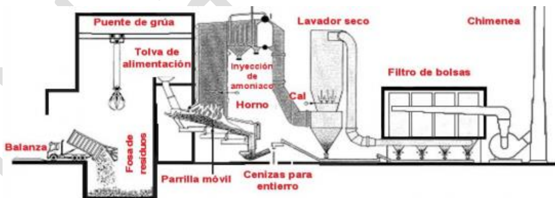
Figura 1. Diagrama de proceso incineración de residuos sólidos municipales (Fuente: https://www.energia Debate.com/blog/2133/ )
