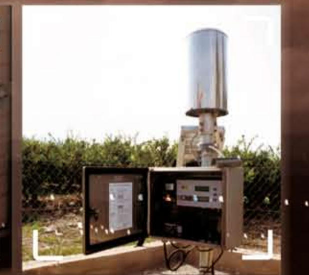
Un moderno pluviómetro automático. La cantidad de lluvia recogida en el cilindro superior se procesa de forma automática y los datos se transmiten por línea o por radio a las oficinas de la AEMET.
