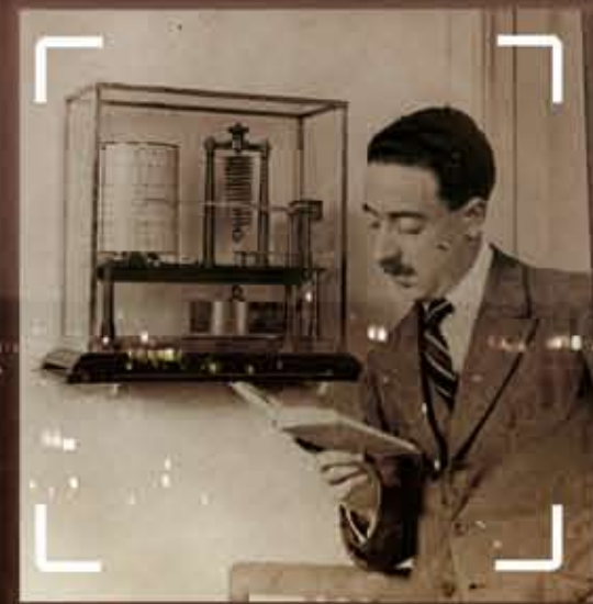
El registro continuo de la presión atmosférica se obtenía mediante barógrafos, cuyo sensor consistía en un recipiente metálico con paredes muy elásticas, del cual se extraía el aire, y que modificaba su forma cuando la presión atmosférica variaba. Observatorio del Retiro (Madrid) años 20.
