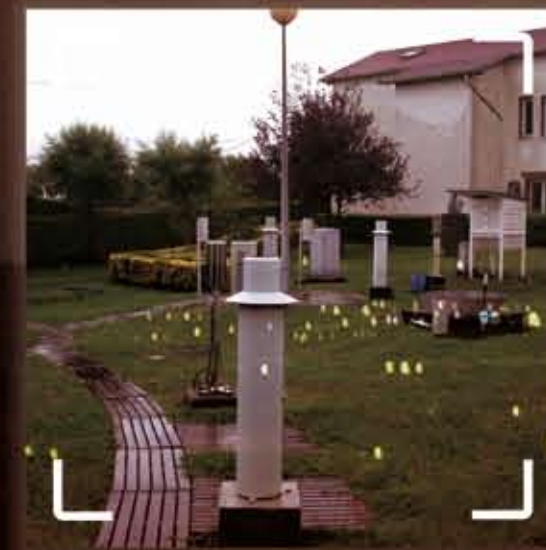
Observatorio meteorológico de superficie (Igueldo, Guipúzcoa). Los instrumentos deben instalarse de manera que sus medidas sean representativas del entorno. Algunos instrumentos, como los termómetros, deben protegerse del sol y otros elementos, introduciéndolos en garitas de madera con rejillas.
