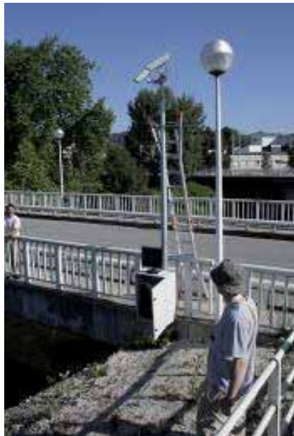
Figura 2. Ilustración de la arqueta de hormigón (50x50x50 cm; A), transmisor de datos via SMS o GPRS (B) y sensor de presión en el cauce (C)
