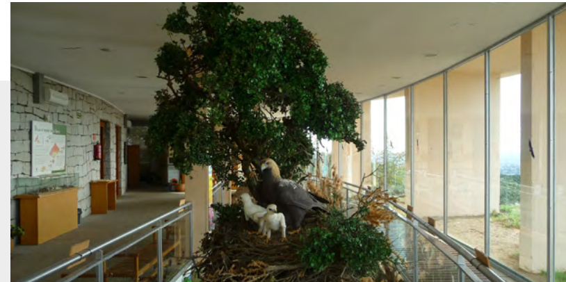
La forma de hemiciclo optimiza la captación solar
