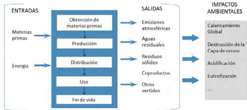
Esquema básico de un ACV
