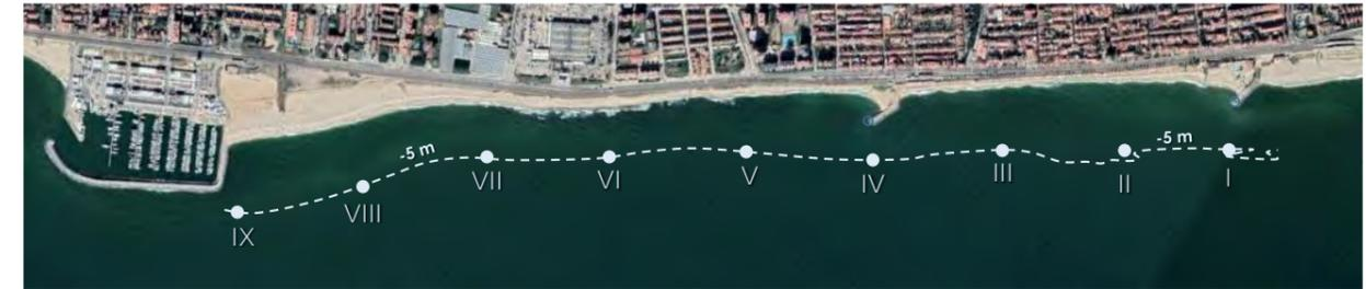
Figura 130.- Puntos en los que se ha calculado la dirección del flujo medio de energía. Fuente: Marciglob
