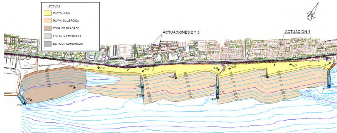
Figura 183.- Planta de las actuaciones 1, 2 y 3 (sin escala, cotas en metros C.A.) de los Proyectos Constructivos.
