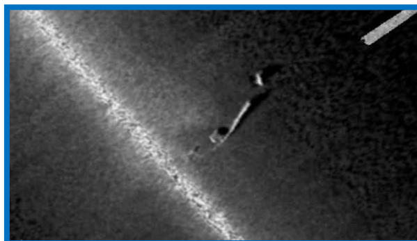
Registro de sonar de barrido lateral donde se detecta la presencia de pecio
