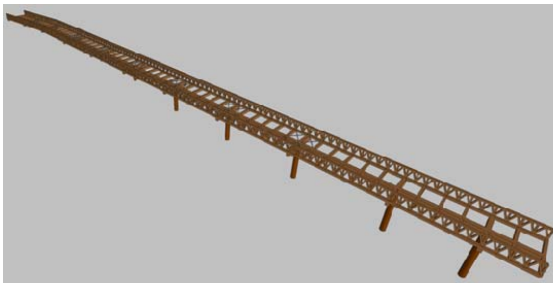
Imagen 1: Vista en 3D de la pasarela en el modelo de la estructura.
