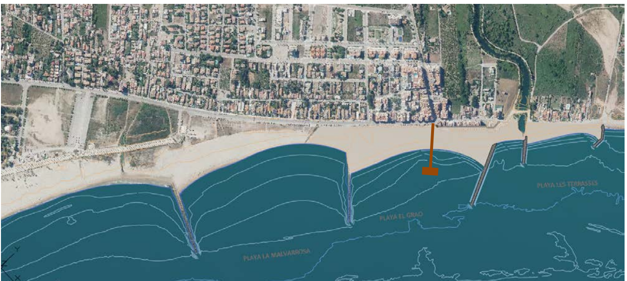
Imagen 14: Planta de equilibrio prevista en el “PROYECTO CONSTRUCTIVO PARA LA ESTABILIZACIÓN DEL ENTORNO DE LA DESEMBOCADURA DEL RÍO ANNA EN BURRIANA (CASTELLÓN)” en la que se marca la planta de la pasarela.
