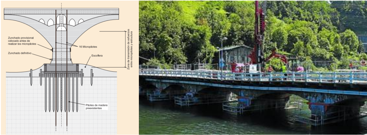
Figura 49. Solución recalce conexión directa
