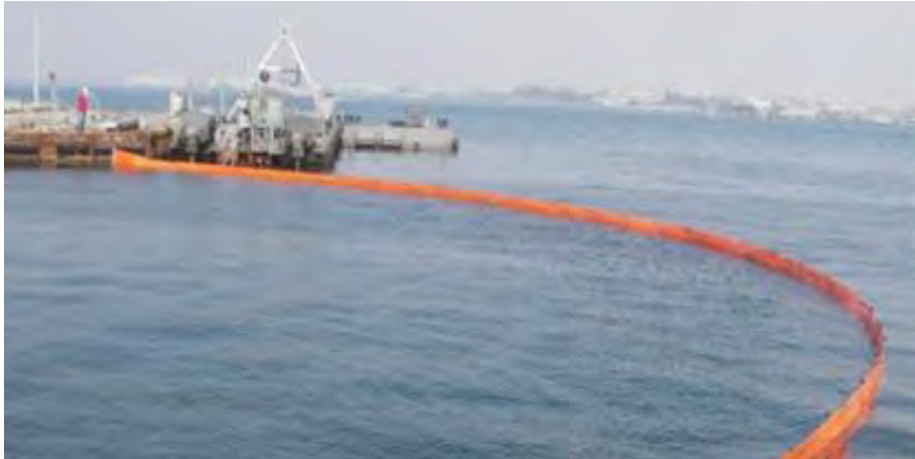
Ejemplo de barrera de contención contra hidrocarburos
