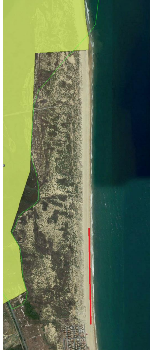
Figura 10. Alcance de la erosión derivada del espigón.
