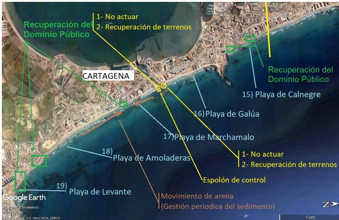
Figura 2.11: Actuaciones propuestas en las playas de Galúa y Marchamalo de Cartagena (Zona 1 C) (Foto: Google Earth)
