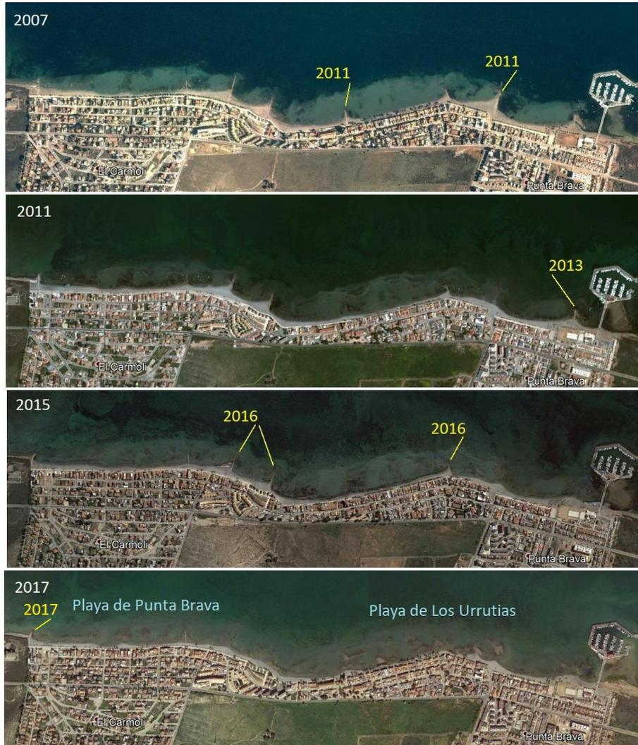
Figura 1.19. Retirada progresiva de los espigones de las playas de Los Urrutias y Punta Brava (Foto: Google Earth)
