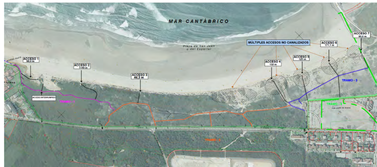
Figura 6 Tramos de pasarelas y de accesos a la playa a sustituir
