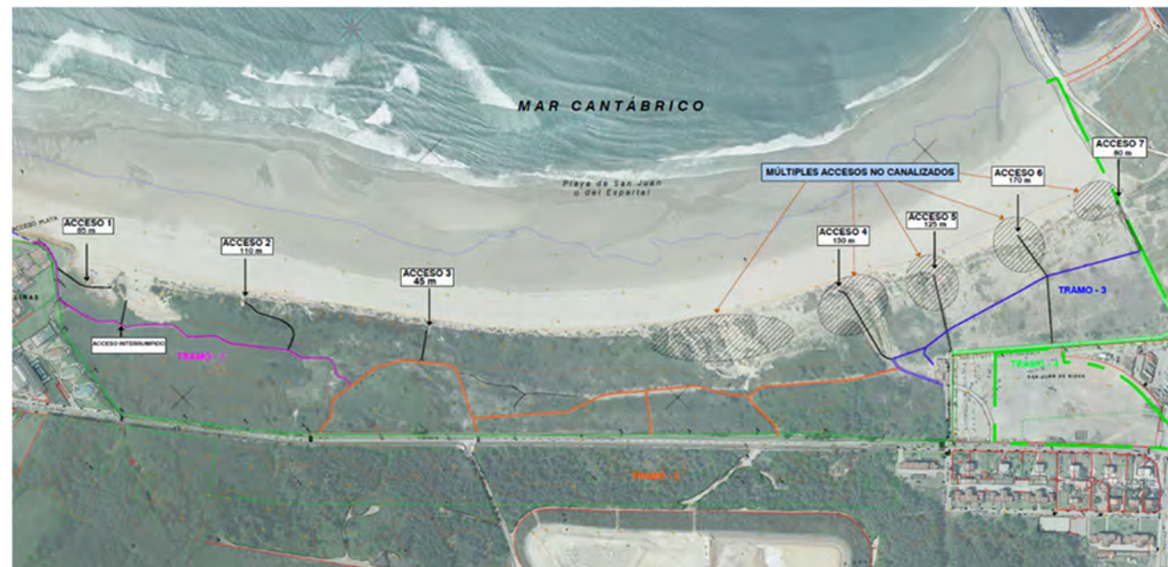
Figura 13 Tramos de pasarelas y de accesos a la playa a sustituir
