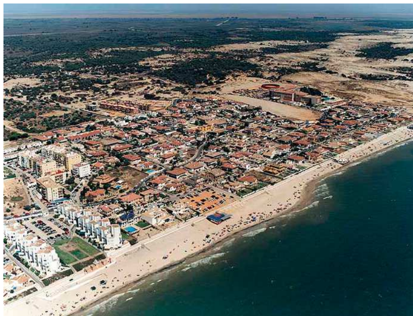
Figura 1.18: Matalascañas, donde la anchura de playa es reducida para los oleajes que inciden en ella; habiéndose producido problemas por esa causa (fuente: Guía de Playas, Dirección General de Sostenibilidad de la Costa y del Mar)
