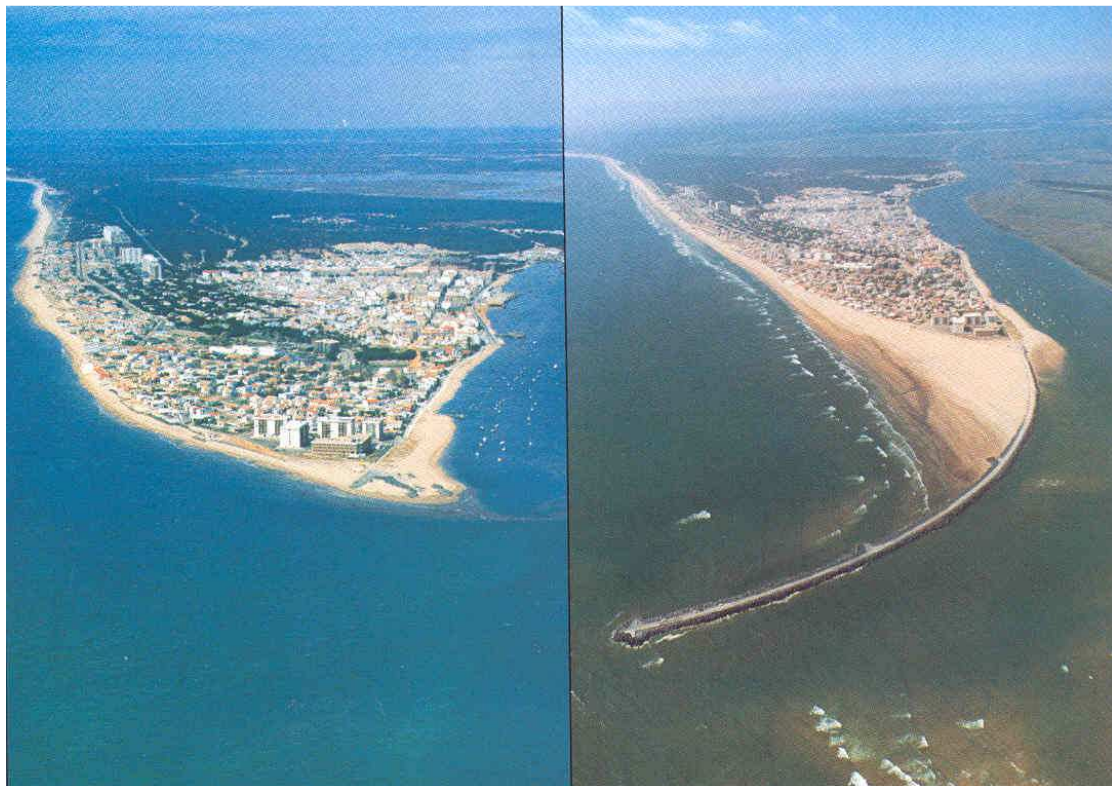
Figura 1.14: Flecha y playa de Punta Umbría antes (izquierda) y después (derecha) de la actuación costera para frenar las erosiones tras la construcción del dique de encauzamiento en la margen de poniente de la desembocadura del río Guadiana (fuente: Dirección General de Costas)
