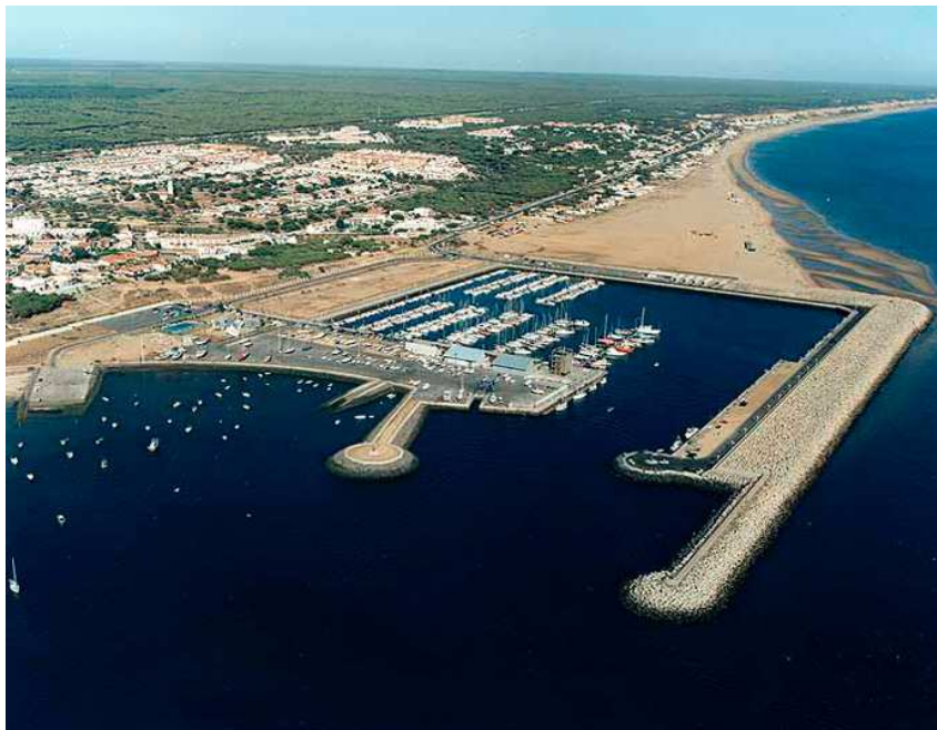
Figura 1.16: Puerto de Mazagón, en la entrada de la ría o puerto de Huelva, construido en 1993 que ha formado una gran playa apoyada (fuente: Guía de Playas, Dirección General de Sostenibilidad de la Costa y del Mar)
