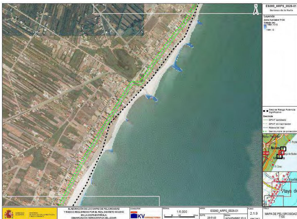
Figura 1.5: Mapa de peligrosidad para T=100 años en la playa de Nules (Fuente: Elaboración de los Mapas de peligrosidad y Riesgo requeridos por el Real Decreto 903/2010 en la costa española. KV Consultores)
