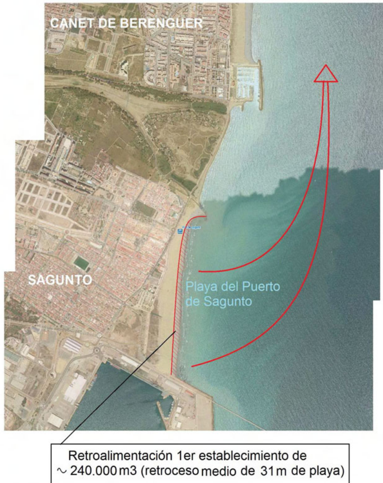
Figura 6.35: Actuaciones propuestas en el Tramo II entre el puerto de Canet de Berenguer y el puerto de Sagunto (foto: DGSCyM)
