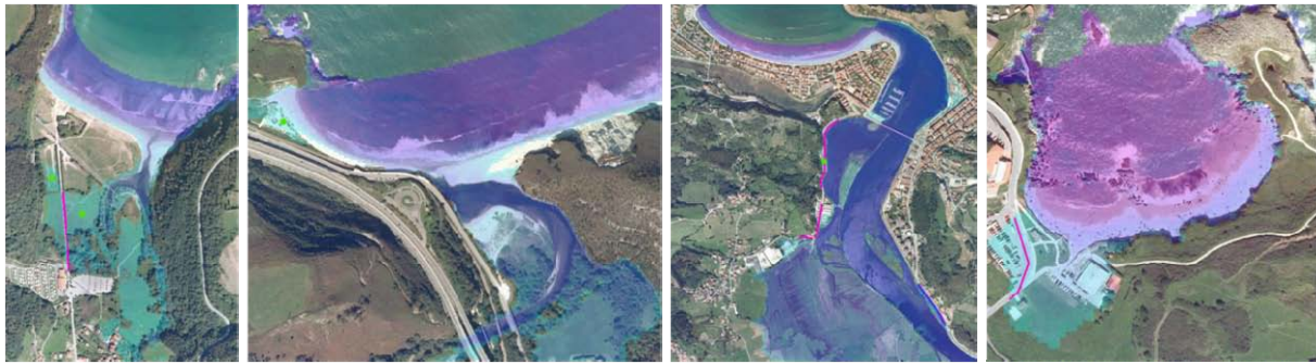
Figura 3.241. Detalle de las infraestructuras críticas afectadas en San Pedro (panel izquierdo), San Antolín (panel en centro-izquierda), Ribadesella (panel en centro-derecha) y Toró (panel derecho) para E1: Evento extremo de 100 años de periodo de retorno en el clima actual.
