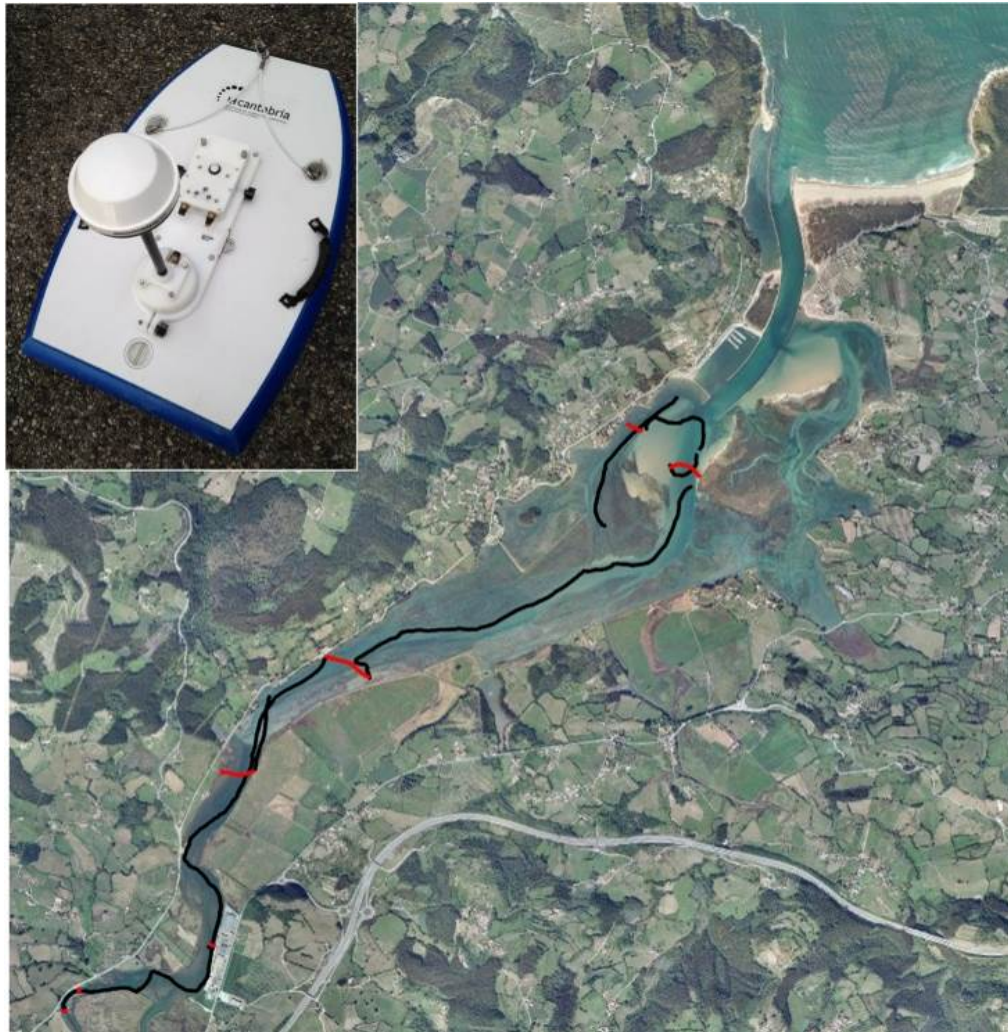
Figura 5.9. Perfiles longitudinales y transversales de medida con el equipo "River Surveyor".
