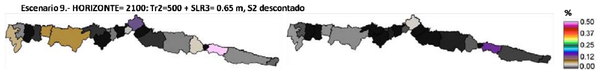
Figura 3.111. Stock de capital de vivienda - continente afectado para E9: Evento extremo de 500 años de periodo de retorno con un aumento del nivel medio del mar de 0.65 m a 2100 (valor medio modificado localmente), considerando los resultados proyectados y descontados. Daño máximo (panel izquierdo) y daño efectivo (panel derecho).
