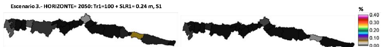
Figura 3.84. Stock de capital de vivienda - contenido afectado para E3: Evento extremo de 100 años de periodo de retorno con un aumento del nivel medio del mar de 0.24 m a 2050, considerando las proyecciones de las variables socioeconómicas. Daño máximo (panel izquierdo) y daño efectivo (panel derecho).
