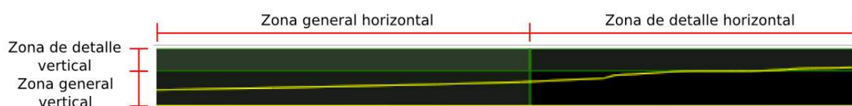
Figura 36. Esquema de las zonas generales y de detalle en una malla de cálculo del IH2VOF.
