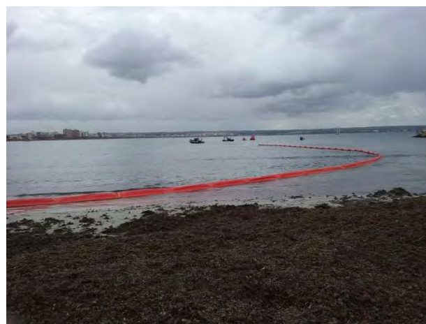
Figura 10: Barrera cilíndrica desplegada
