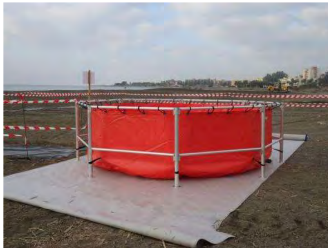
Figura 2: Depósito 10.000 l con estructura metálica
