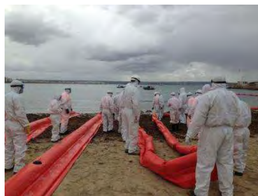
Figura 8: Barrera cilíndrica desplegada
