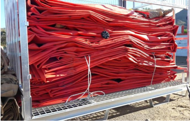
Ilustración 3. Barreras selladoras dispuestas en jaulón
