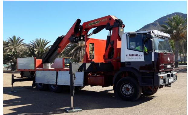
Ilustración 7. Camión pluma. Transporte y descarga
