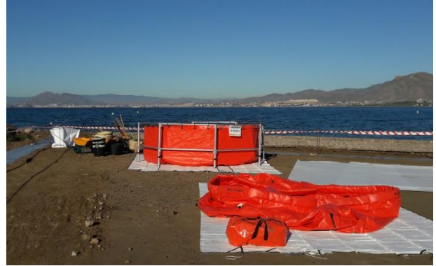
Ilustración 6. Fast tank y tanque autoportante
