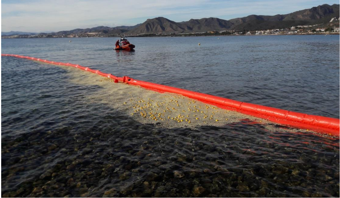
Ilustración 21. Mancha de fuel simulada con palomitas de maíz y naranjas
