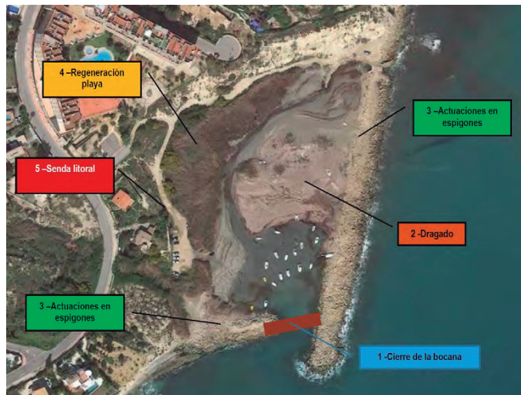
Proceso constructivo previsto.
