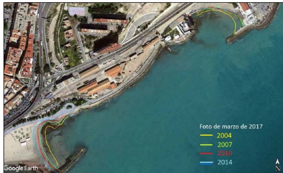
Figura 41 Líneas de orilla de la playa de El Postiguët-Cocó y el Club de Regatas entre 2004-2014 sobre una foto de 2017.
