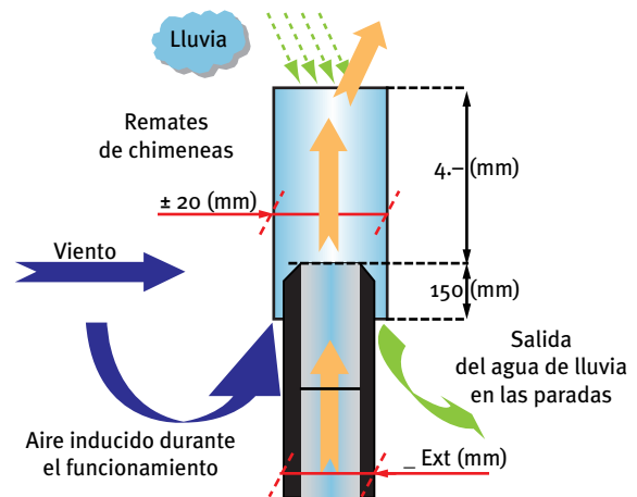
Figura INSTCLD-05: Remates de las chimeneas para una correcta dispersión de los humos
