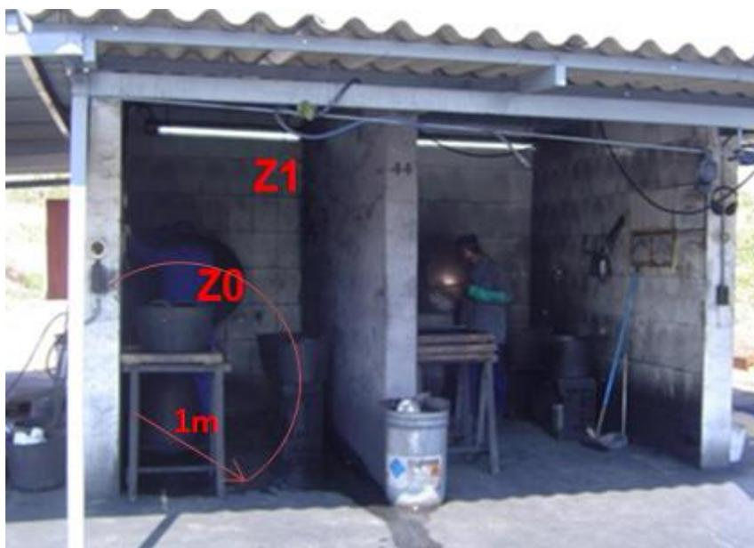
**Ilustración 2:** Casetas abiertas al exterior para fabricación de color
