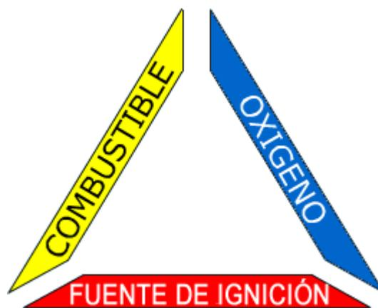
Figura 7.1 Triángulo del fuego
