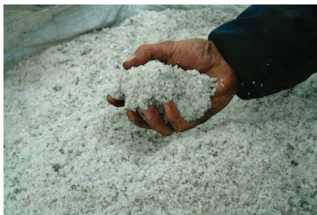
Figura 77. Sal para extinción de incendios
