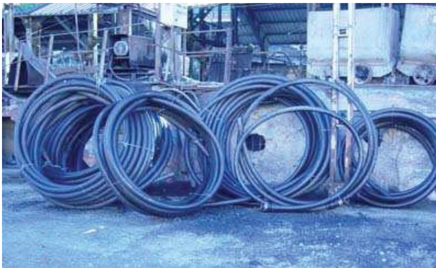
Figura 85. Tubería de PVC de conducción de nitrógeno para frentes de galería
