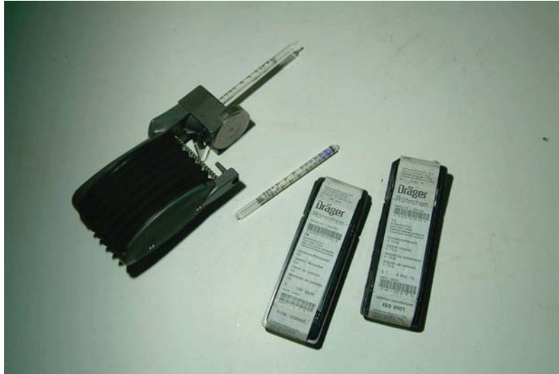
Figura 60. Detección de gases mediante tubos colorimétricos
