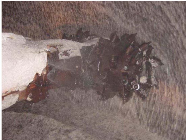
Figura 42. Inyección de agua en las picas de un minador
