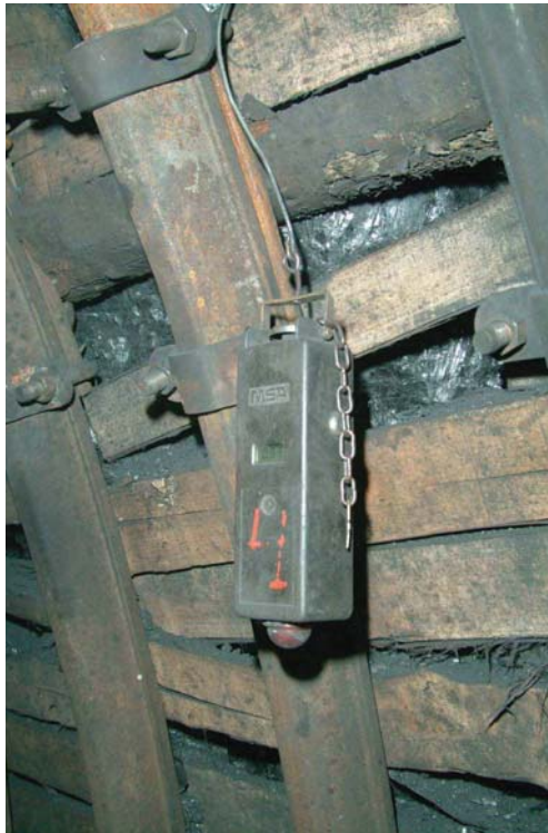
Figura 40. Metanómetro portátil que genera alarma óptica o visual
