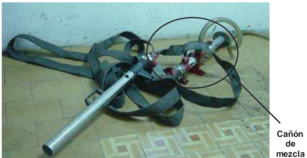
Figura 78. Sistema extintor mediante espumas
