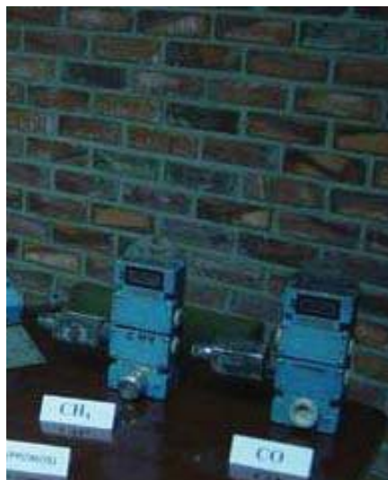
Figura 63. Detectores de metano y monóxido de carbono
