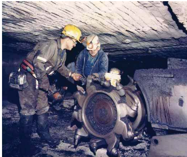
Figura 43. Mantenimiento de picas de una rozadora
