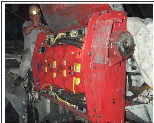
*Fotografía C.3 Sistema de extinción automática instalado en un minador*
