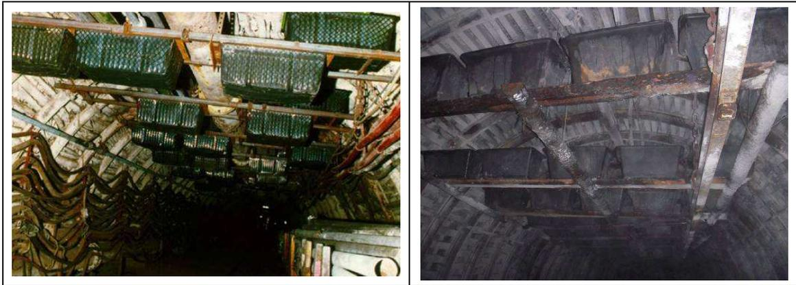
Fotografía C.1. Barreras de cubas de agua dispuestas en el techo de las galerías
