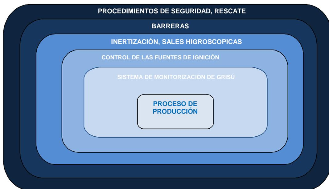
*Figura C.1 Niveles de medidas de protección en minas subterráneas de carbón*
