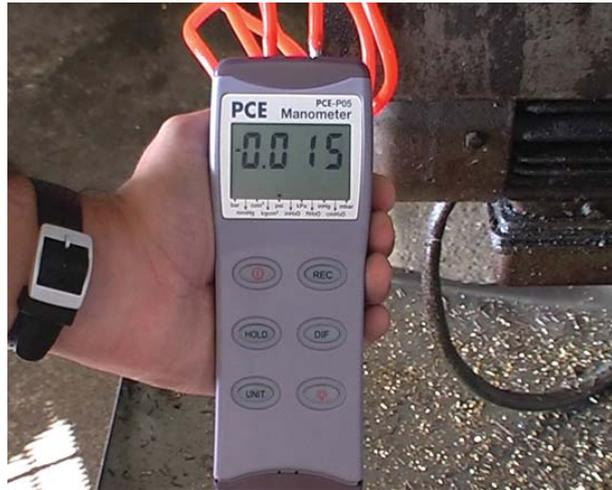
Figura 2.14: Medidor de presión diferencial
