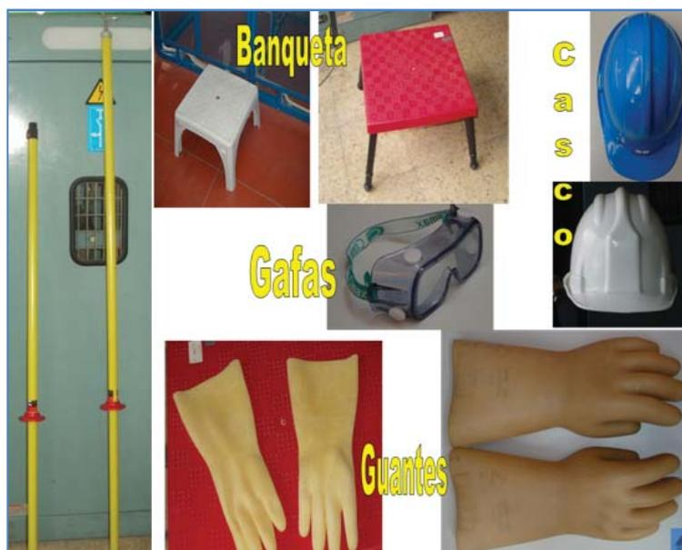
Figura 1.5: Equipos de Protección frente al Riesgo Eléctrico
