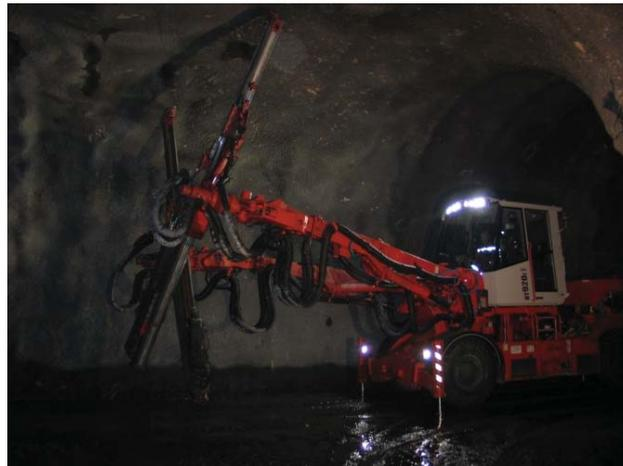
Figura 4.1: Jumbo de perforación Axera T9-i
