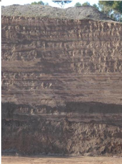
*Detalle de la estratificación y formas de erosión en el talud analizado*
