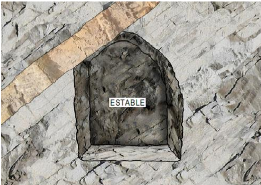
Figura 97 - Adaptación del hueco de la excavación a la litología y estructura geológica. (S.N.M.P.E, 2004).
