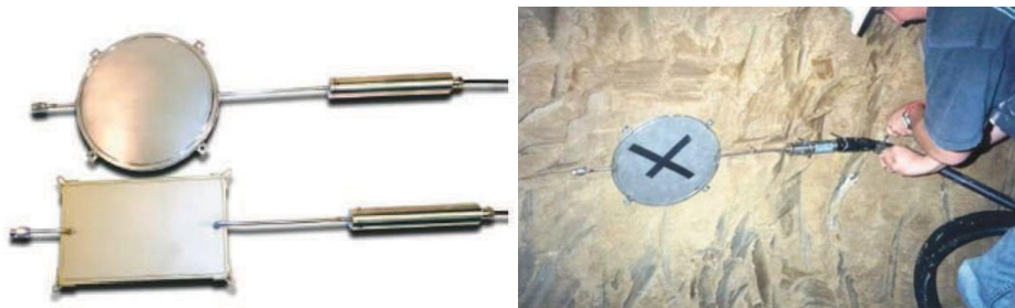
Figura 73 - Células de presión e instalación, (MTC, 2014).
