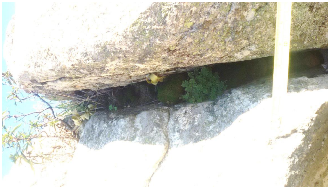
Figura 19- Relleno arcilloso con vegetación en juntas de afloramiento rocoso de granito de Valdemanco, CAM (Foto: A.Berrocal).
