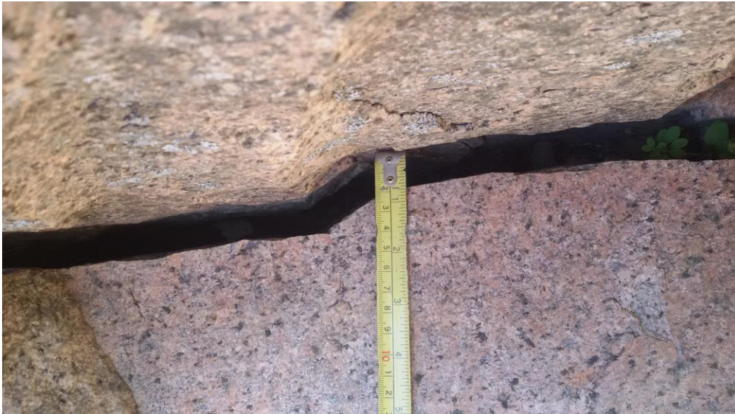
Figura 17- Junta clase VI, ancha. Granito de Valdemanco, CAM (Foto: A.Berrocal).
