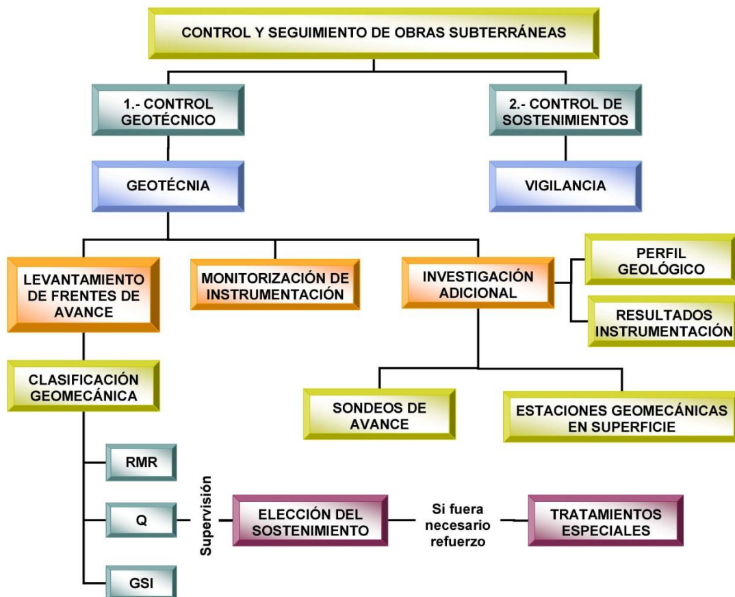
Figura 71 - Proceso de control y seguimiento de una excavación subterránea.
