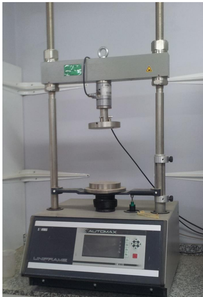
Figura 2- Equipo para ensayo de resistencia a compresión simple, (Estudios Mikar S.L.).
