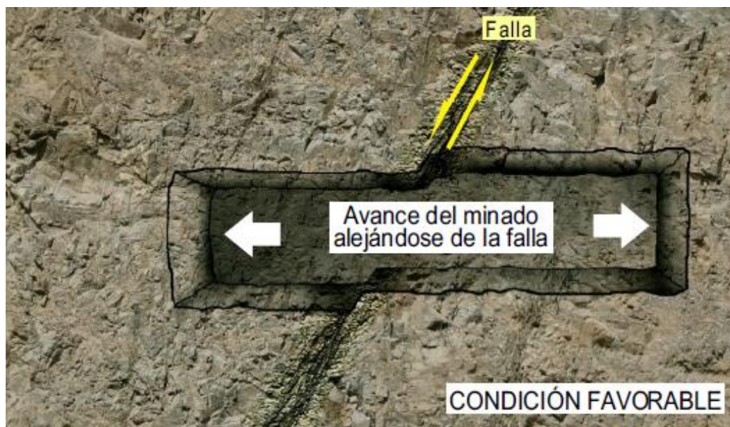
Figura 99 - Avance del frente alejándose de una zona de falla hacia posiciones más seguras, (S.N.M.P.E, 2004).
