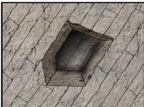
Figura 93 - Muestra diversas formas de excavaciones en función del terreno condicionado por planos geológicos estructurales, y las tipologías de cuñas que se originan (S.N.M.P.E, 2004).
