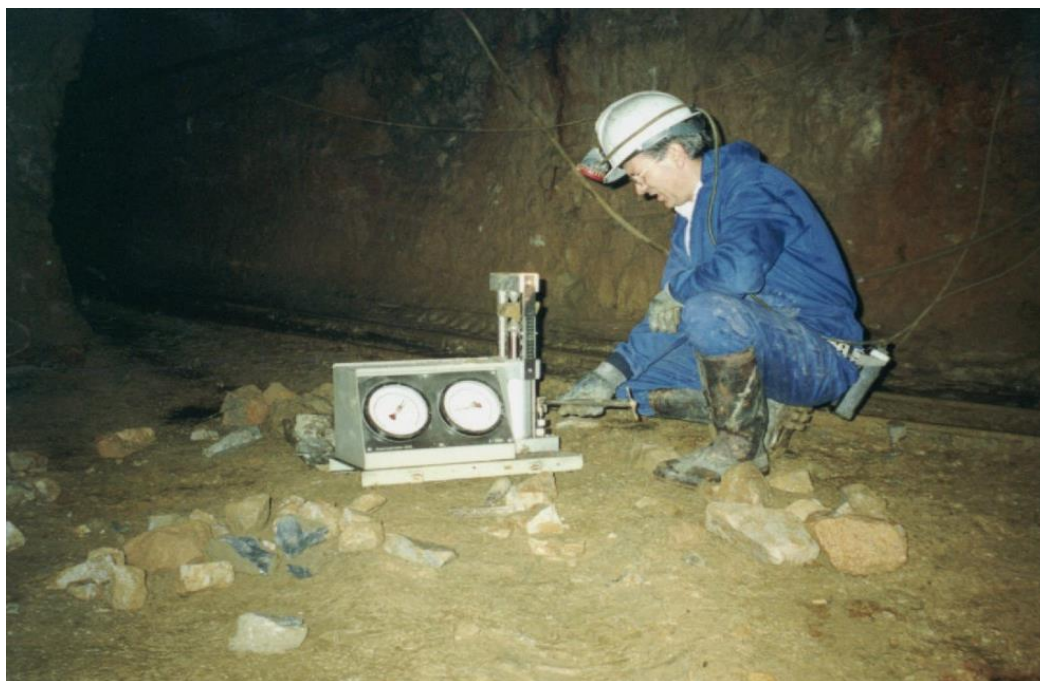
Figura 4- Ensayo de carga puntual con Prensa Franklin (Inproobras S.L.).
