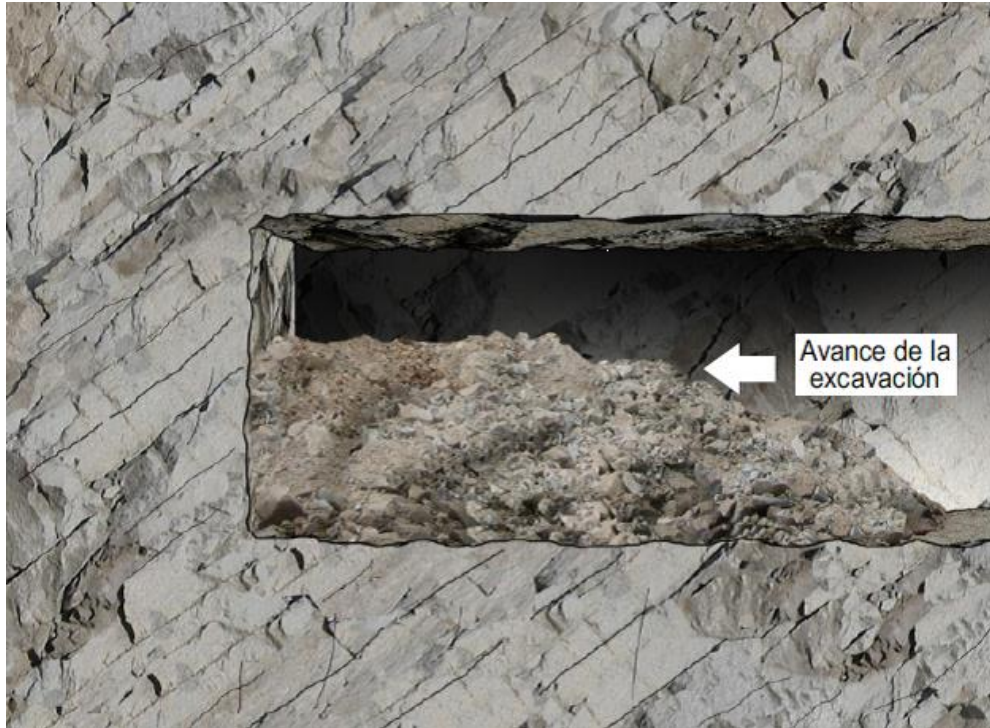
Figura 87 - Excavación a favor del buzamiento. La relación entre el avance y la orientación de las discontinuidades del macizo rocoso son favorables. (S.N.M.P.E, 2004).
