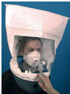
Fig. I.4. Test de ajuste cualitativo (Fuente: 3M)
