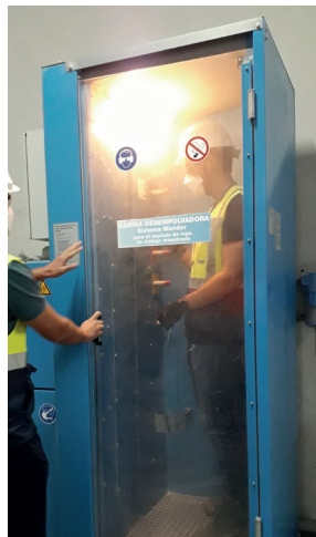
Fig. 6.1. Cabinas de limpieza de personal (Fuente: INS)
