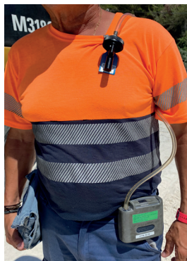
Fig. 3.7. Trabajador portando equipo de muestreo personal (Fuente: INS)
