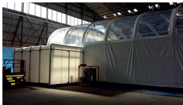
Fig. 5.2. Distintos ejemplos de cerramientos a presión negativa (Fuente: www.duroair.com )
