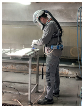
Fig. 6.9. Trabajador con EPR filtrante asistido (Fuente: INS)
