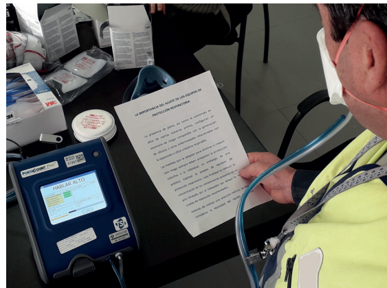
Fig. 11.3. Formación práctica en ajuste de EPR (Fuente: INS)
