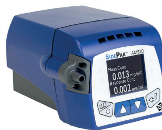
Fig. 7.3. Ejemplo de detector portátil (Fuente: www.tsi.com )
