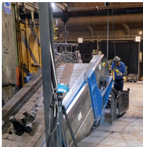
Fig. 3.3. Concentración de fracción respirable de partículas y estimación de SCR. (Fuente: INS)
