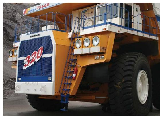
La Dirección tiene una importancia notable a la hora de hacer maniobras ya sea para entrar al punto de carga o para situarse en la posición adecuada para vaciar la caja del Volquete. El ángulo de giro de los neumáticos varía de uno a otro fabricante, estando entre los 35 y 40º en la mayoría de los casos.
