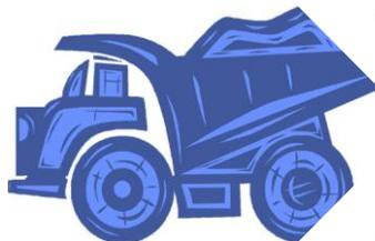
**Recuerde:** Evite que el volquete sitúe sus ruedas posteriores sobre el material con el que va a ser cargado. Eliminará así posibles cortes en ellos y el riesgo de reventón.
