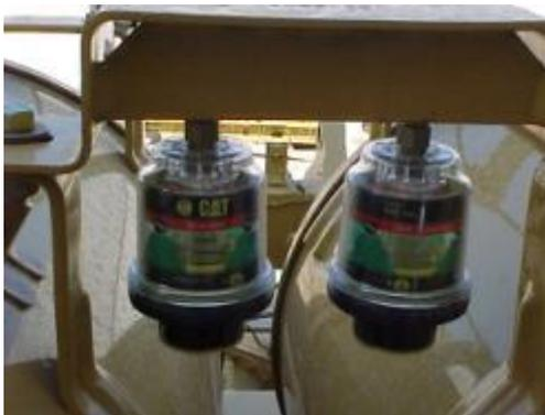
Un indicador, instalado ya sea en la base del filtro o en la cabina, advierte al operador cuando hay que darles el mantenimiento. La misión de los filtros de aire es vital para el motor; basta una pequeña grieta por la que entren partículas de polvo para que éstas erosionen las cabezas de los pistones y
