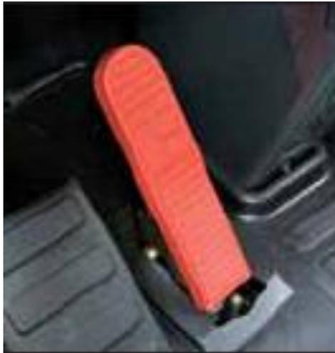
En los Volquetes, por este último motivo, se le suele llamar con el nombre de Freno Secundario y puede estar controlado bien por una palanca situada debajo del volante en el lado izquierdo de la caña de la dirección, o, como en los modelos más modernos, por un pedal situado a la izquierda.
