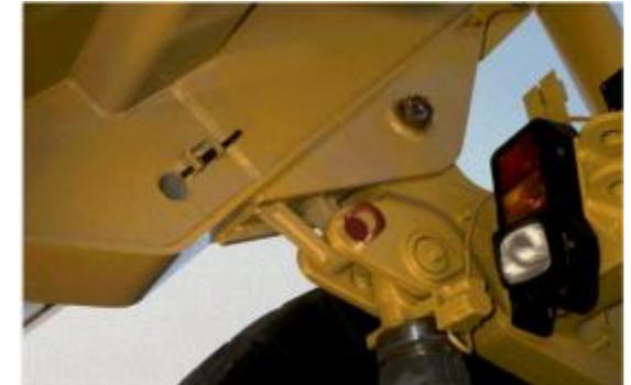
En las reparaciones, hay veces que se deben hacer pruebas con el motor en marcha, y las personas tienen que trabajar en una zona con riesgo de atrapamiento; este riesgo se evita conectando los bloqueos mecánicos que acabamos de explicar.
