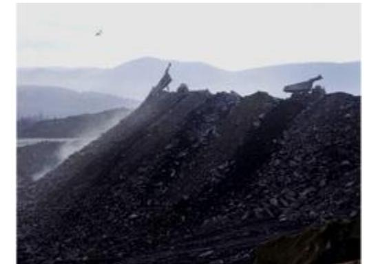
Para realizar la Descarga, el Volquete o Camión debe retroceder hacia el borde del Vacie hasta un punto que, siendo suficientemente seguro, permita que la Carga sea vaciada fuera de la escombrera en su totalidad, o, al menos, en su mayor parte. Las Normas que explicamos anteriormente, son de vital
