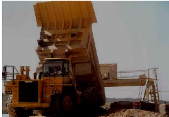
Las Tolvas suelen estar situadas en una superficie horizontal y disponen de una plataforma con suficiente amplitud como para que el Volquete o el Camión puedan hacer las maniobras necesarias sin dificultad.
