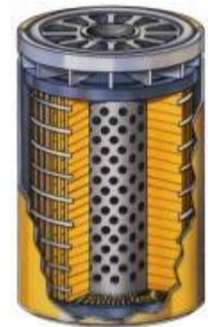
Una vez que atraviesa el filtro, el aceite está totalmente limpio, y preparado para pasar por los conductos de engrase que, por lo general, son de muy pequeño diámetro. Este filtro debe cambiarse pasadas las horas que indica el fabricante de la Máquina; no obstante, si se llega a obstruir, el circuito dispone de una válvula de seguridad que envía el aceite al resto sin pasar por el filtro; no es una buena situación, pero siempre es preferible a que algún punto del motor se quede sin engrase.
