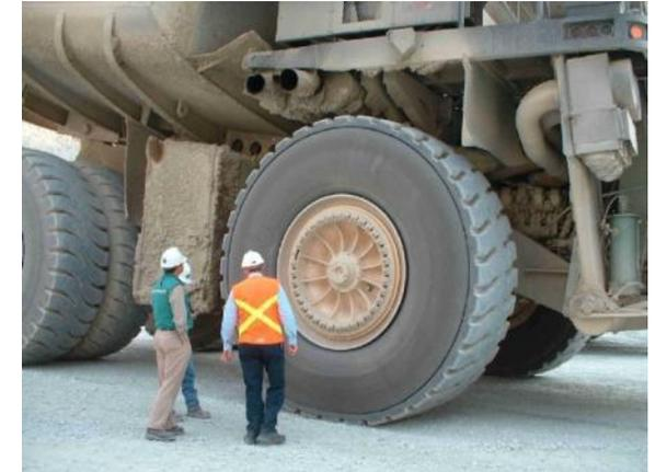
⇒ El **Índice tonelada-kilómetro/hora** es un método desarrollado por CATERPILLAR, para clasificar los Neumáticos. Se basa en que cuando el Neumático se calienta se puede producir un fenómeno inverso al que tuvo lugar durante su fabricación.
