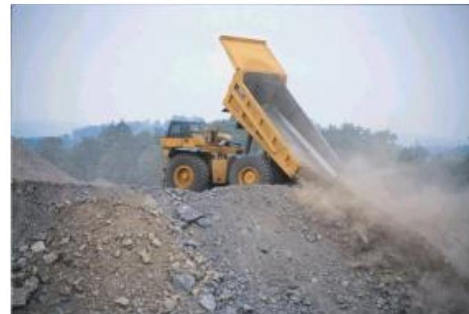
1. **Elevación de la Caja.** Situando el control en la posición “subir” y llevando el motor a un régimen suficiente para que la bomba tenga la potencia necesaria para elevar la carga y la caja; por lo general, suele ser suficiente un régimen de 1.800 rpm, si bien puede variar de uno a otro fabricante.
