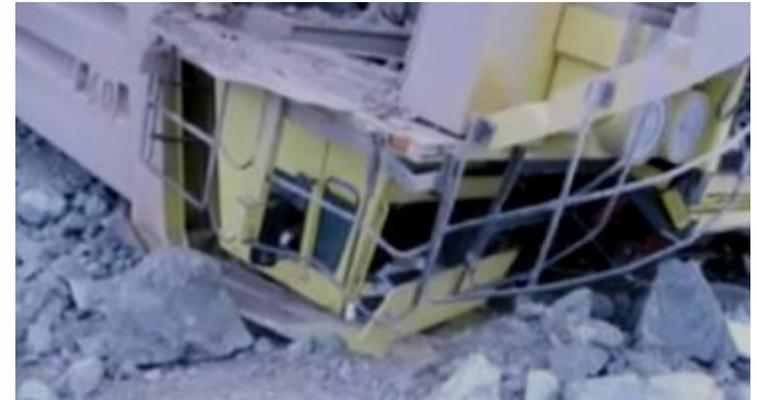
Estas protecciones pueden ser estructuras visibles desde el exterior, o estar integradas dentro de la propia Cabina, pero el resultado es el mismo. Son obligatorias en máquinas que incorporan el marcado CE, y deberían llevarla todas aquellas que, en cumplimiento del RD 1215, han sido armonizadas a las condiciones exigidas por el Mercado CE.
