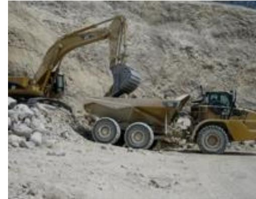
Es misión del Operador de la Cargadora el mantener la Zona de Carga en perfecto estado, eliminando los obstáculos que se puedan producir, rellenando posibles hoyos con material fino y dejando la superficie de rodadura plana y libre de materiales extraños.
