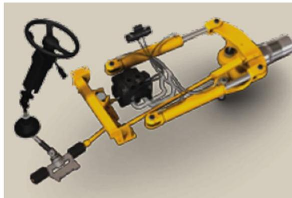
Estos cilindros tienen su cuerpo unido al bastidor delantero y los vástagos al conjunto de enganche del bastidor posterior. El aceite para la Dirección puede estar en el mismo depósito que el de los frenos y basculante o, como en el caso de algunas marcas, ser independiente del resto de circuitos; en este caso, suele estar en el lado derecho del Volquete, y dispone de su mirilla de nivel, filtro, etc.
