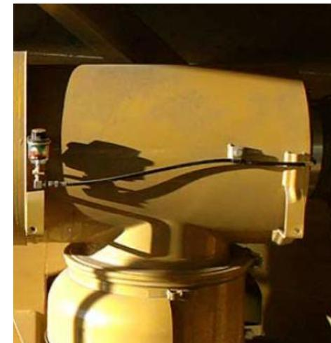
Por lo que se refiere al **filtro de aire**, el Indicador tradicional ha sido durante muchos años, un pistón que se mueve dentro de la carcasa de plástico transparente en el que está fabricado; en el caso de una buena aspiración, es decir, con el filtro en buenas condiciones, la succión es capaz de mantener el pistón en una posición en la que muestra una banda verde.
