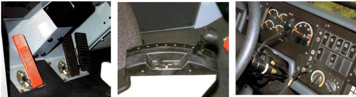
A la derecha del asiento, se suele encontrar la palanca de cambios, que, situada en una determinada posición, permite a la Transmisión cambiar entre primera y la marcha limitada por ella. Ya se explicaron con anterioridad las protecciones que brinda el Control Electrónico antes situaciones no adecuadas para el Tren de Potencia. Junto a la palanca de cambios, se encuentra el mando del freno de estacionamiento.
