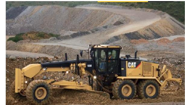
Por la cantidad de trabajos que pueden hacerse con ella, todos con gran precisión, resulta muy difícil su manejo, sobre todo, cuando no se llevan a cabo frecuentemente. Trabajos tales como el Refino de taludes, apertura y limpieza de cunetas, extendido de montones, etc., son algunas de las tareas habituales de las Motoniveladoras.
