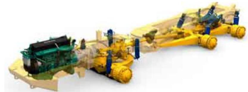
Otra solución adoptada por algún fabricante es la combinación de muelles y cilindros amortiguadores en ambos ejes posteriores, teniendo una disposición similar a la utilizada en automoción.
