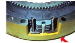
El Tren Planetario forma un conjunto completamente equilibrado en lo que se refiere a los ejes de todos sus engranajes, por lo que su vida útil es muy superior a las de tipo Contraeje. Según sea el elemento por el que entra el par que llega del Convertidor, las conexiones entre los distintos componentes de los diferentes Trenes y por cuál de los elementos salga el par, se obtienen las diferentes reducciones que proporciona la caja.
