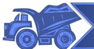
**Recuerde:** Para descargar en una escombrera, sitúe el volquete con el eje trasero paralelo a su talud y a una distancia del borde segura.
