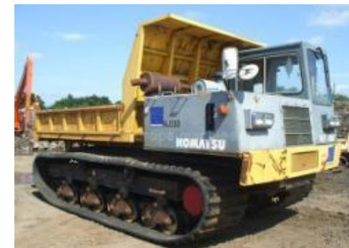
helados. Su tamaño apenas alcanza cargas superiores a 25 toneladas, y, consecuencia de su diseño sobre cadenas, transmite al suelo una presión inferior a 1 kg/cm<sup>2</sup>.
