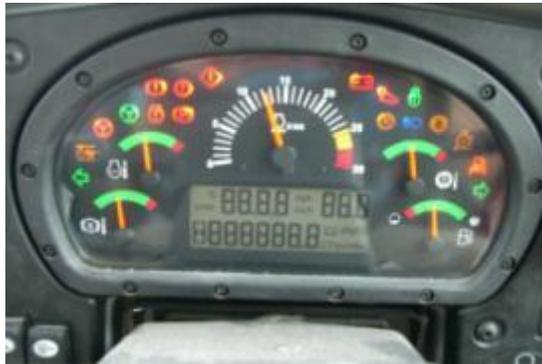
En caso de anomalía, una luz roja se enciende en el Panel de Alarmas, advirtiendo al Operador de esta circunstancia; en función de la posible gravedad del circuito de que se trate, la alarma óptica puede ir acompañada de otra acústica que avisa al Operador del riesgo que está corriendo, él o la Máquina.
