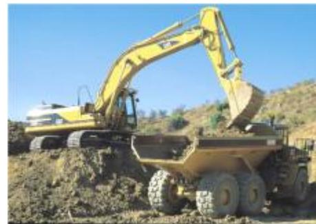
Para cualquier posición del Volquete, éste debe tener sus ruedas posteriores apoyadas sobre suelo firme, **nunca sobre piedras aunque sean de pequeño tamaño**, para evitar posibles cortes o reventones de los neumáticos.
