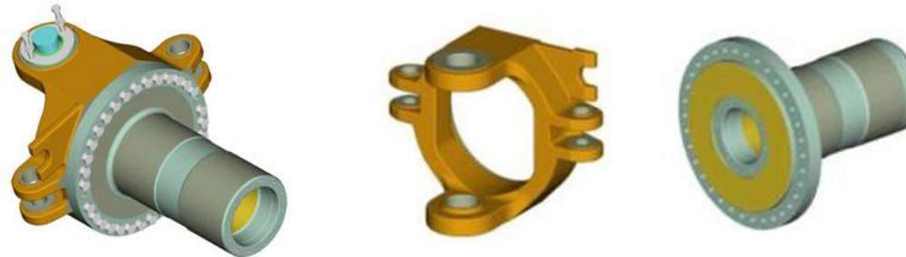
En esta figura, correspondiente a la alternativa escogida por otra marca, puede verse su montaje, que aloja en su interior un árbol de transmisión, que dispone de dos cojinetes de bolas y otro en la junta de la articulación de dobles rodillos cónicos.
