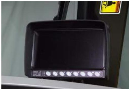
Por lo que se refiere a la visibilidad de la parte posterior, las marcas están ofreciendo como una opción la incorporación en la Cabina una pantalla conectada con un visor electrónico situado en el eje trasero del Volquete que permite disponer de una visión panorámica, con lo que le Operador domina toda esta zona, evitando así un posible atropello. Este es un Dispositivo de Seguridad que aún no es obligatorio en las Máquinas.
