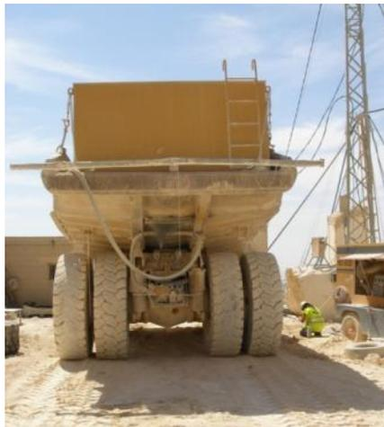
coloca sobre la propia caja, o bien, directamente sobre el bastidor. En el primero de los casos, es fundamental **anular** el sistema hidráulico de elevación para evitar el riesgo de vuelco y **adaptar** la Operación de la Máquina a las nuevas condiciones de estabilidad (*prestaciones de los sistemas de frenado y de dirección - este último, sobre todo, en las curvas - que puede provocar la naturaleza de la nueva carga*).
