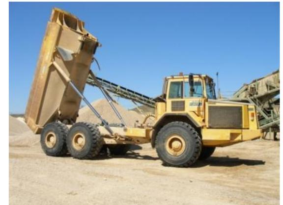
Para esta operación, los Volquetes disponen de un Sistema Hidráulico que suele utilizar el mismo aceite de los frenos; dos cilindros hidráulicos son los encargados de este movimiento; según su longitud, están formados por **cuatro o cinco etapas**.
