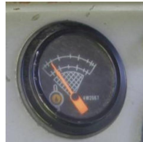
En cualquiera de los casos de temperatura excesiva del aceite, si, después de un “calentón” y de haberse enfriado, se cambia la forma de trabajar y, a pesar de todo, vuelve a una temperatura excesiva, hay que parar definitivamente la Máquina porque hay alguna avería o anomalía importante que se sale de las atribuciones del Operador y que puede dañar gravemente la unidad.
