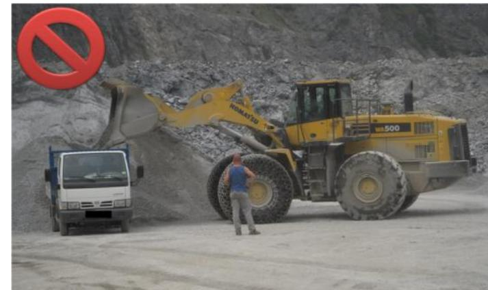
Si la Pala o la Excavadora son demasiado grandes para el tamaño de la Unidad de Transporte (situación que se puede dar con más frecuencia en el caso de Camiones), la descarga debe hacerse lentamente para evitar la caída brusca de la carga sobre la caja que puede producir, además de algún daño al Conductor, graves daños al propio vehículo.
