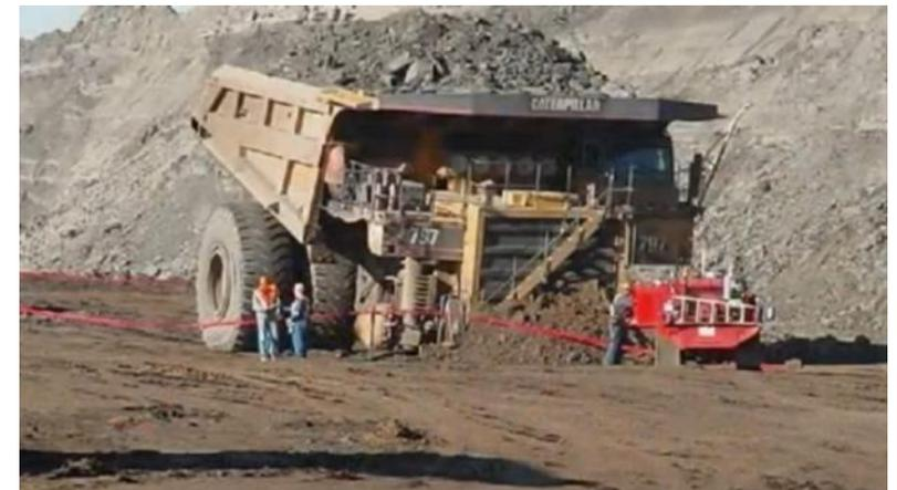
Si la Máquina ha sido llevada al taller, bien sea por sus propios medios o remolcada, es posible que se haya tenido que manipular alguno de los componentes del Sistema de Frenos o de la Dirección; en este caso, debe estar bloqueada por calzos mientras dure la Reparación; se evitan así posibles movimientos inesperados que suponen un riesgo grave de atropello para quienes trabajan en sus proximidades.
