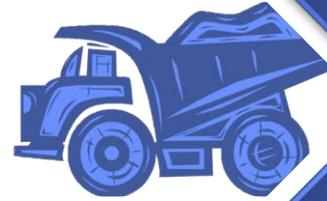
Recuerde: Bajando una pendiente no cambie de dirección, ni lo haga con la transmisión en neutro, ni utilice un sistema de frenado distinto al que recomienda el fabricante. *ii*Existe riesgo de vuelco!!
