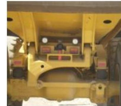
En la figura puede verse igualmente los bloques de elastómero que actúan para absorber los choques que se producen al circular por terrenos desiguales.
