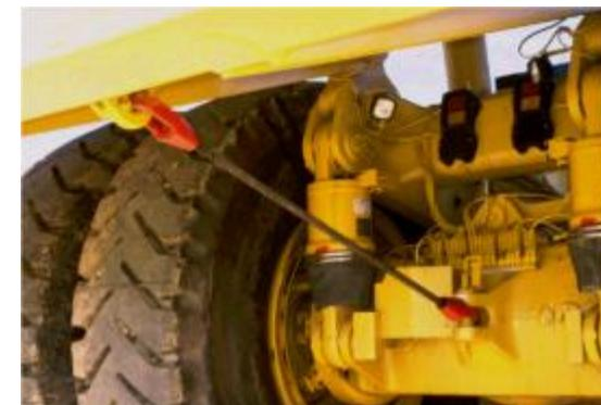
Los Volquetes Rígidos utilizan dos sistemas para inmovilizar la Caja: un cable que la sujeta con el eje trasero o unos bulones que se introducen en unas orejetas que forman parte del bastidor.
