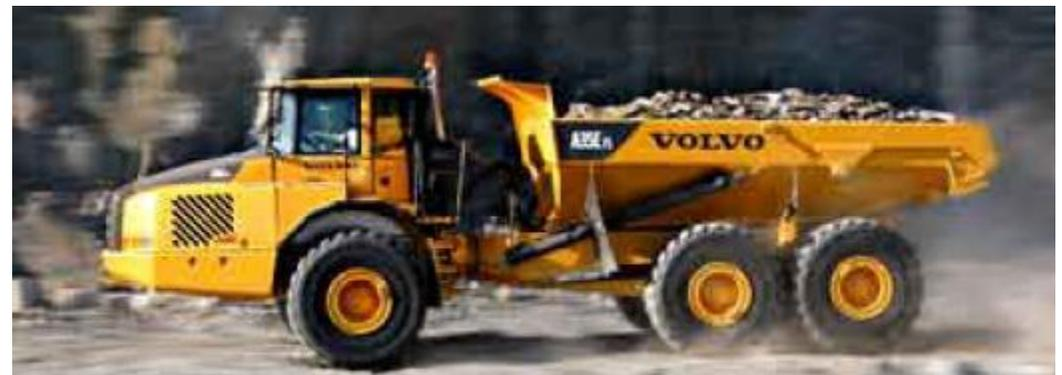
La fabricación de ambos Bastidores es similar a la que hemos explicado en los Volquetes Rígidos; son de acero de alta resistencia, de sección en caja simple en el delantero y de doble caja en el posterior, para conseguir la resistencia necesaria sin penalizar al Volquete con un peso excesivo.
