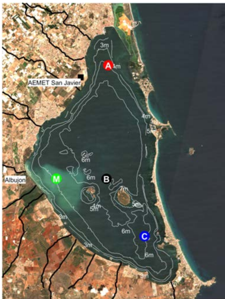
Figura 1: Ubicación de las estaciones de muestreo (A, B, C y M) mostrada sobre una imagen de satélite Sentinel2 obtenida el 03/08/2023. La ubicación de la boya piloto SMLG coincide con B.
