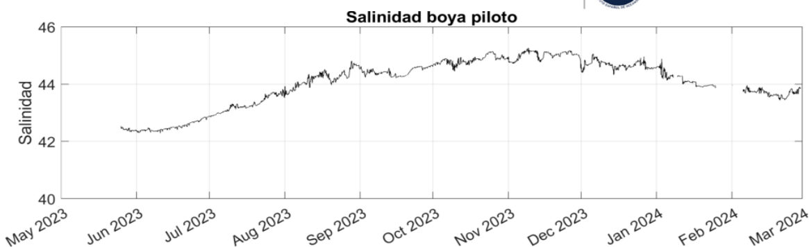
Figura 9: Datos de salinidad de la boya piloto a 6m de profundidad.
