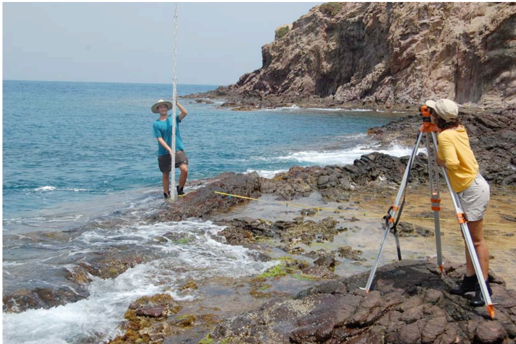
Figura 8. Tomando las “cotas” mediante el uso del topográfico.
